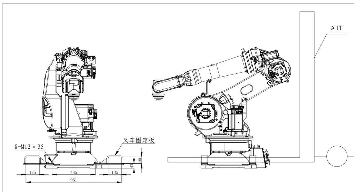
图 1.4 机器人叉车搬运示意图 (ER20-2300-HI)
