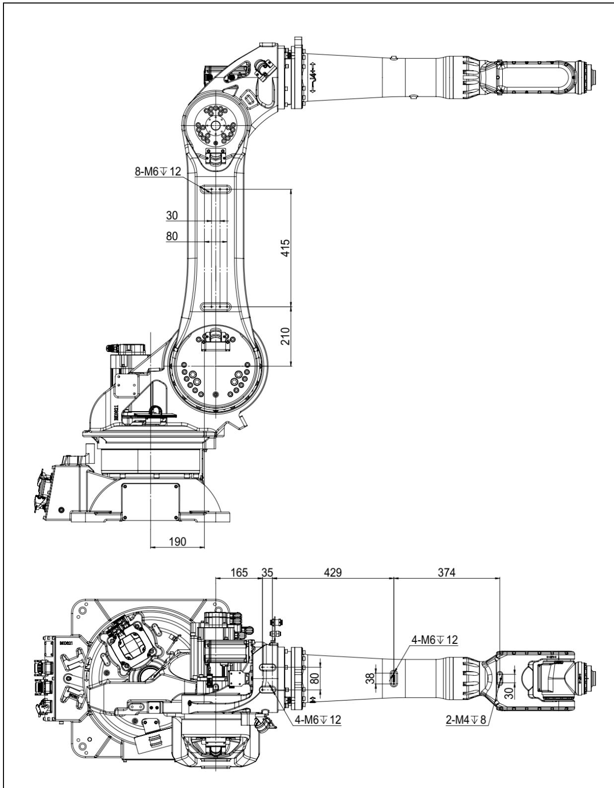
图 4.3 设备安装面尺寸 (ER20-2300-HI)
