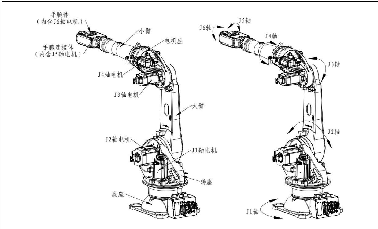
图 3.1 机器人的构成 (ER20-2300-HI、ER30B-2700-LI)
