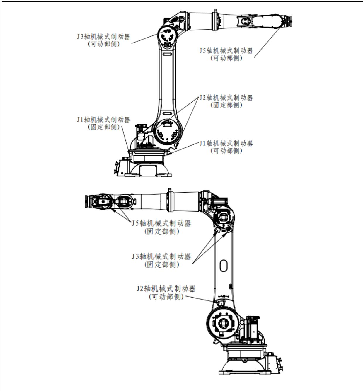
图 3.13 机械式制动器位置 (ER50B-2700)
