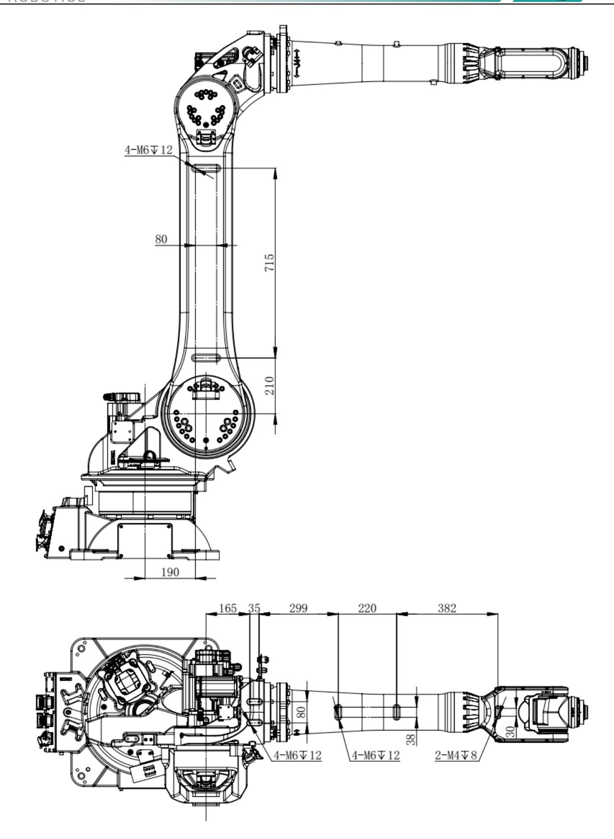
图 4.4 设备安装面尺寸 (ER30B-2700-LI)
