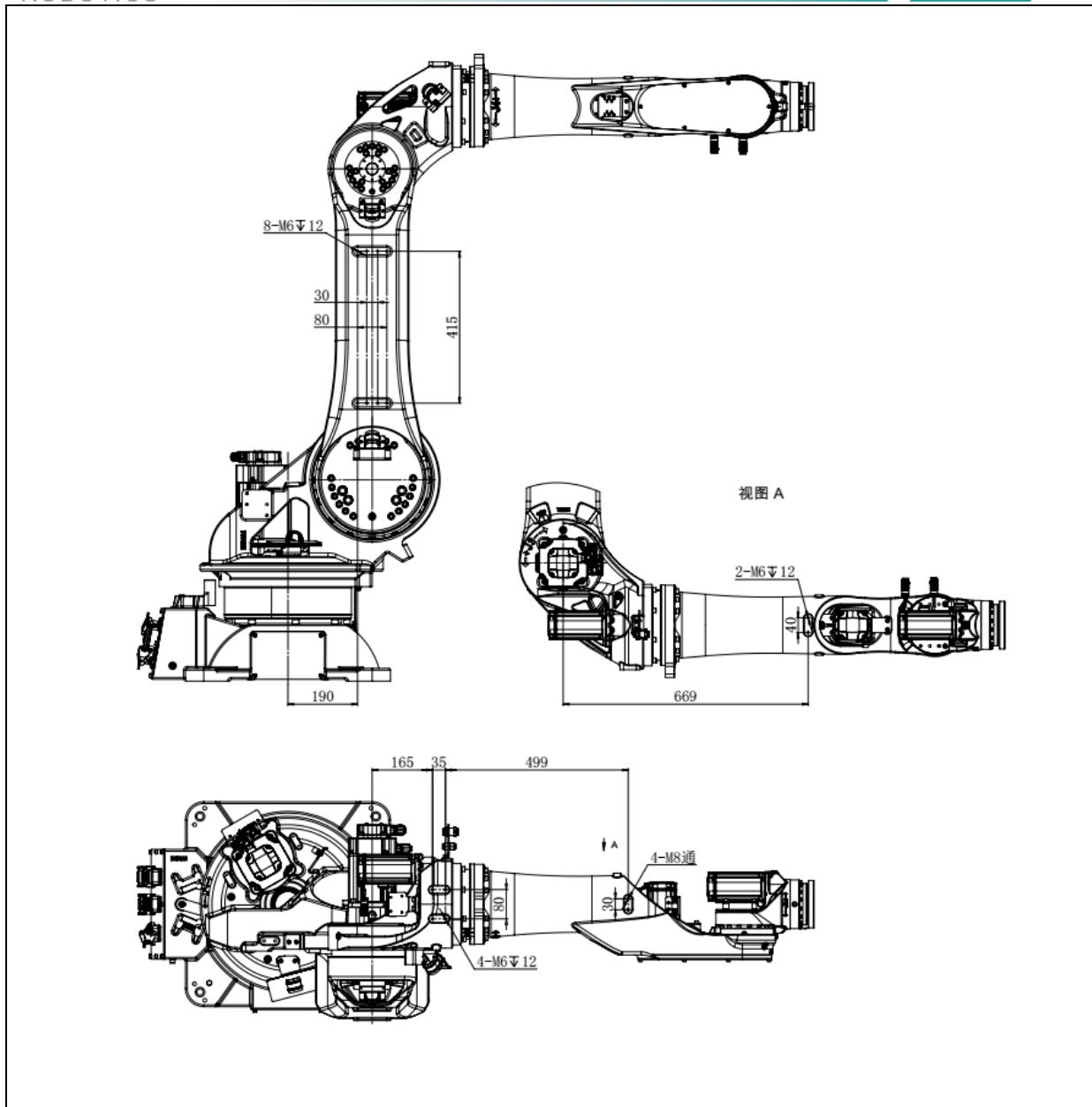
图 4.5 设备安装面尺寸 (ER50B-2100、ER70B-2100-LI)
