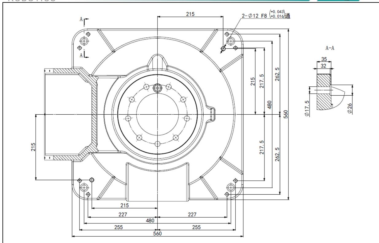
图 1.13 机器人底座安装尺寸
