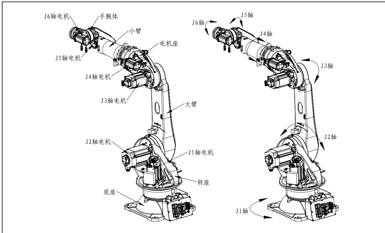
图 3.2 机器人的构成 (ER50B-2100、ER70B-2100-LI)
