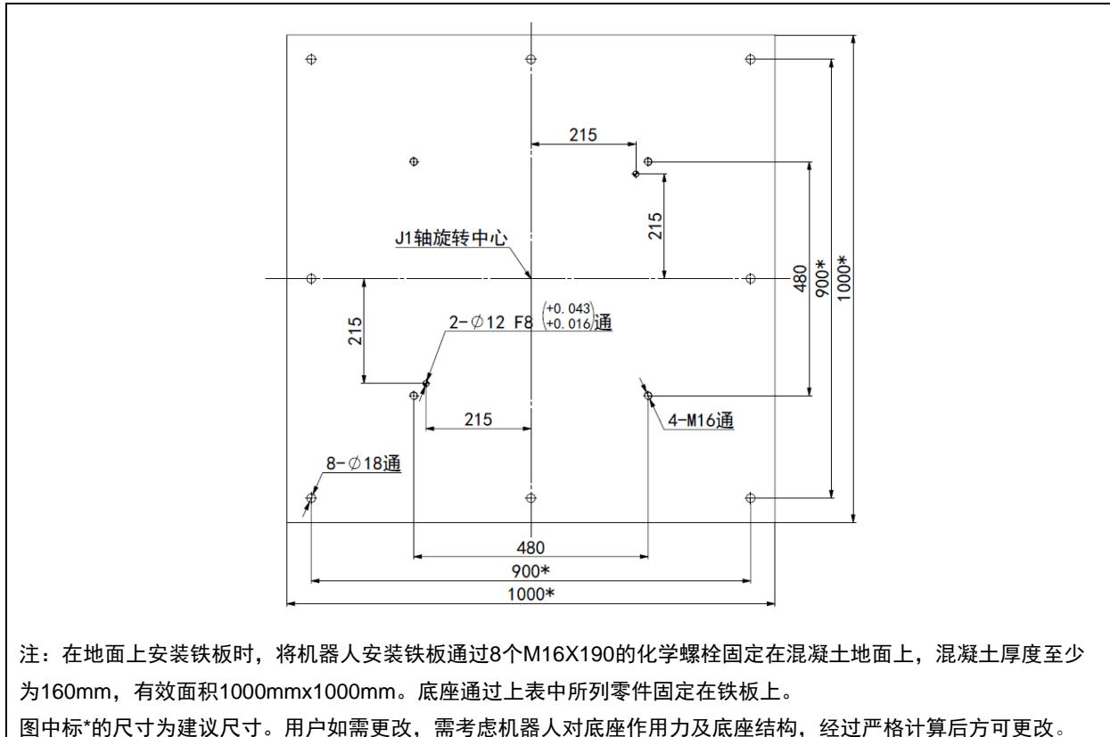
图 1.14 机器人安装铁板尺寸
