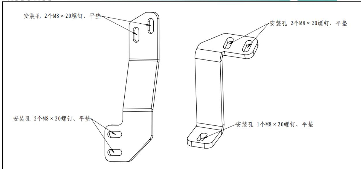
图 1.1 机器人固定支架示意图（ER20-2300-HI、ER50B-2100、ER70B-2100-LI）
