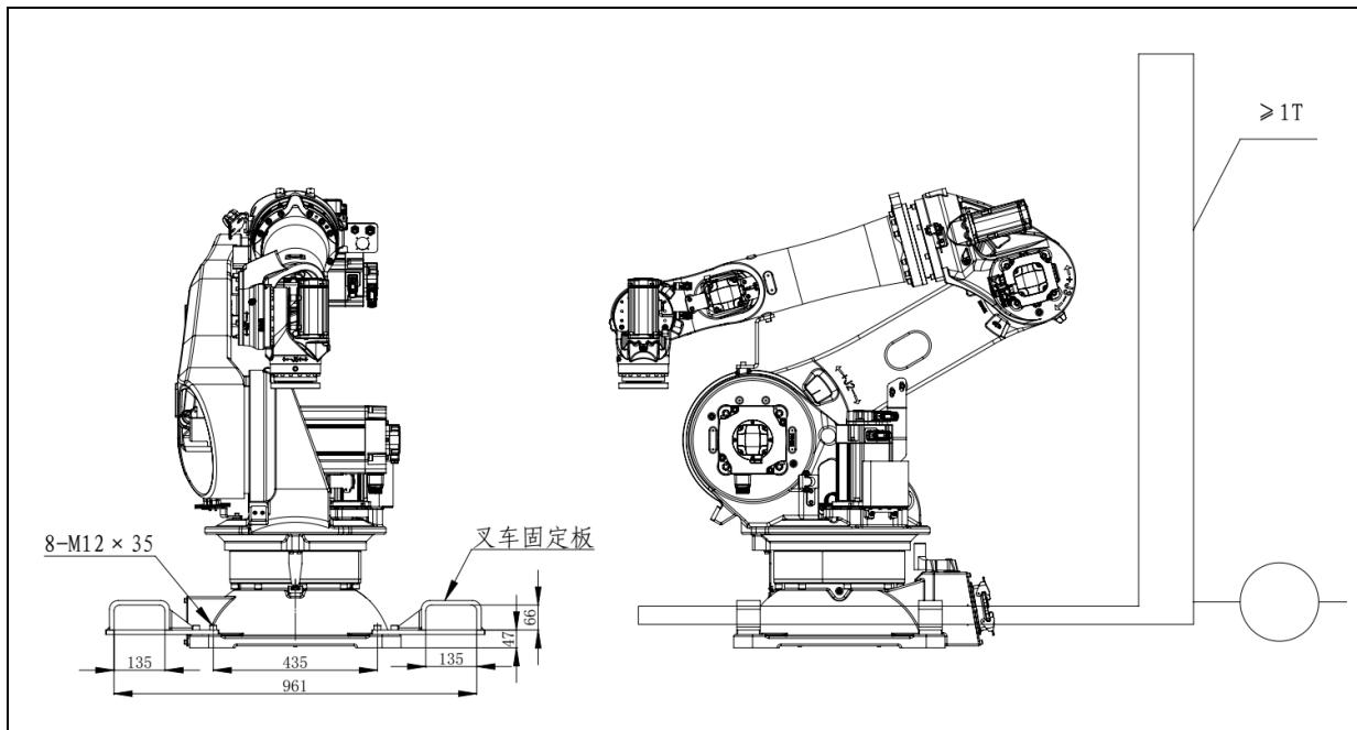
图 1.6 机器人叉车搬运示意图（ER50B-2100、ER70B-2100-LI）
