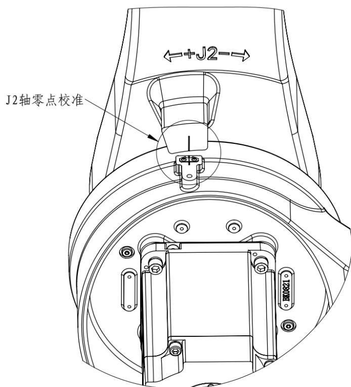
图 6.4 J2 轴校准示意图
