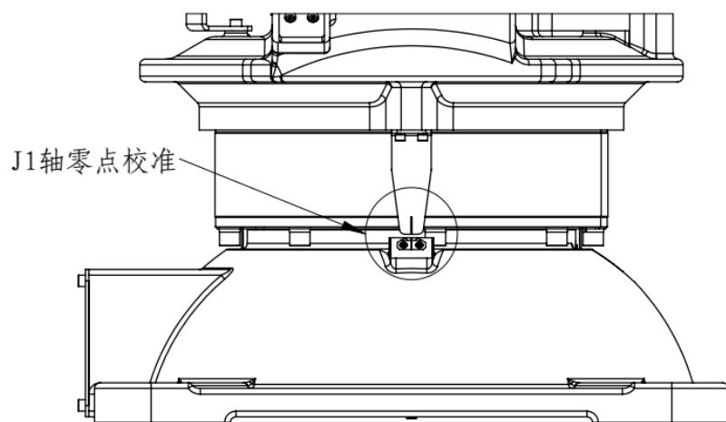
图 6.3 J1 轴零点校准示意图
