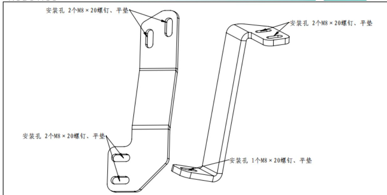
图 1.3 机器人固定支架示意图 (ER50B-2700)
