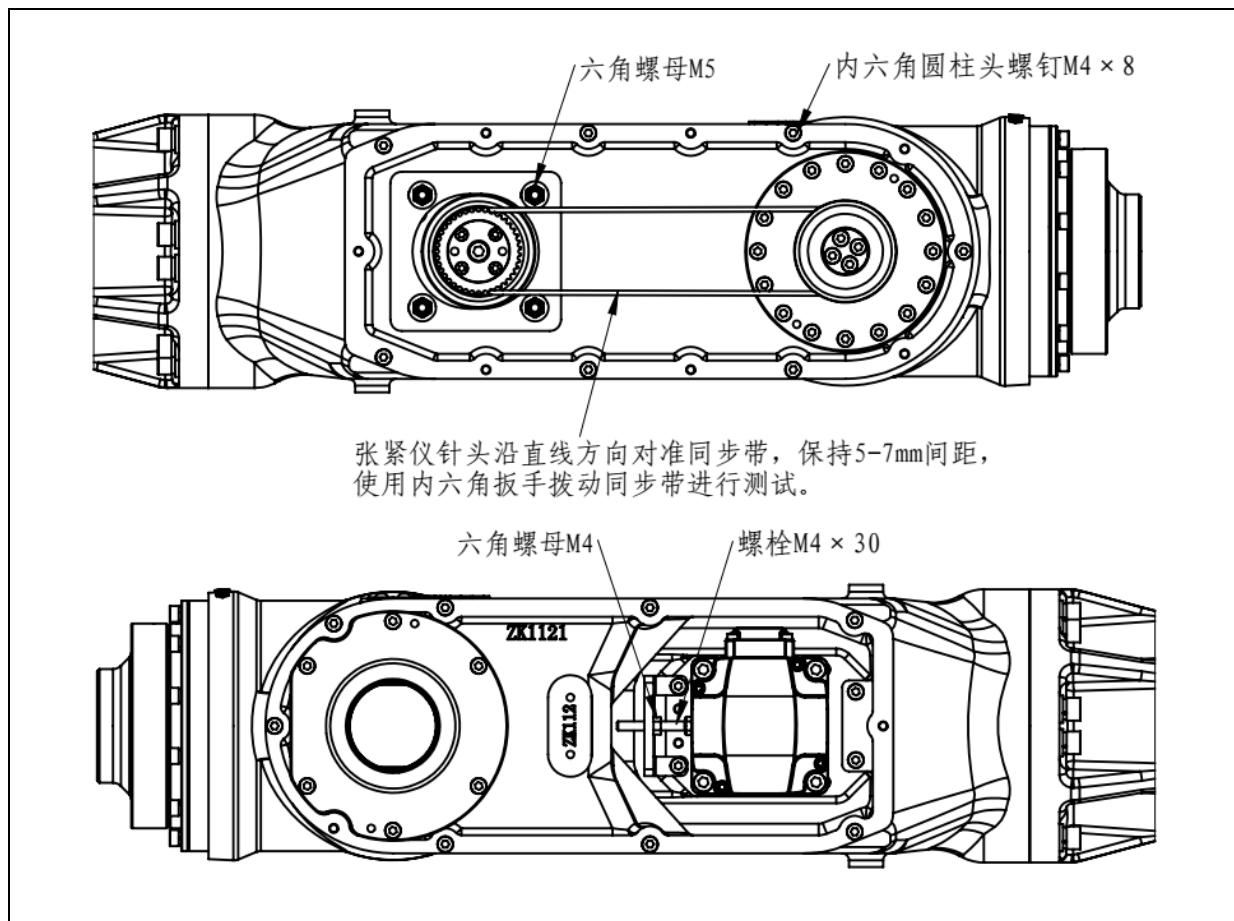
图 5.1 同步带张紧位置示意图 (ER20-2300-HI、ER30B-2700-LI)
