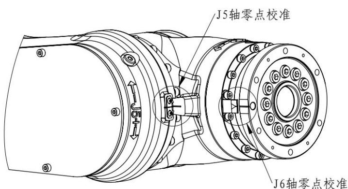
图 6.9 J5、J6 轴校准示意图 (ER50B-2100、ER50B-2700、ER70B-2100-LI)
