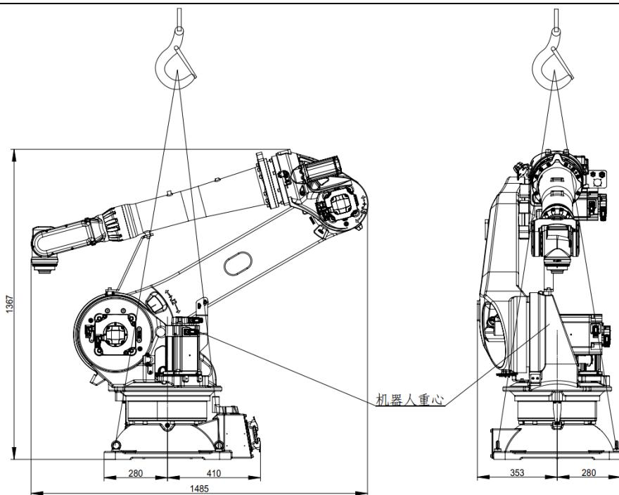
图 1.9 机器人起重机搬运示意图（ER30B-2700-LI）
