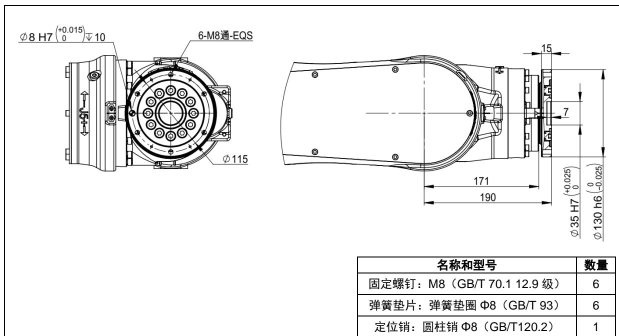
图 4.2 末端法兰安装接口（ER50B-2100、ER50B-2700、ER70B-2100-LI）
