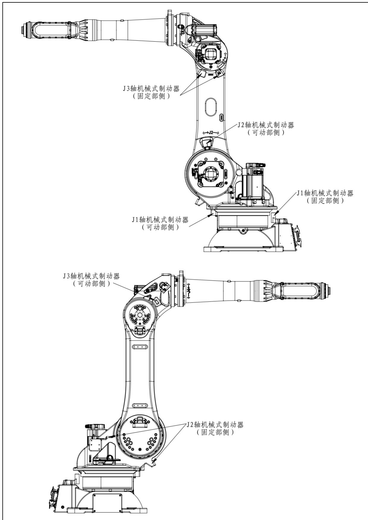
图 3.11 机械式制动器位置 (ER20-2300-HI、ER30B-2700-LI)
