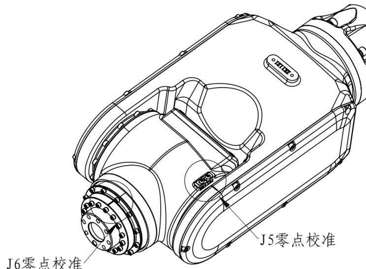
图 6.8 J5、J6 轴校准示意图 (ER20-2300-HI、ER30B-2700-LI)
