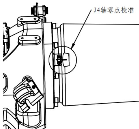
图 6.7 J4 轴校准示意图(ER50B-2700)
