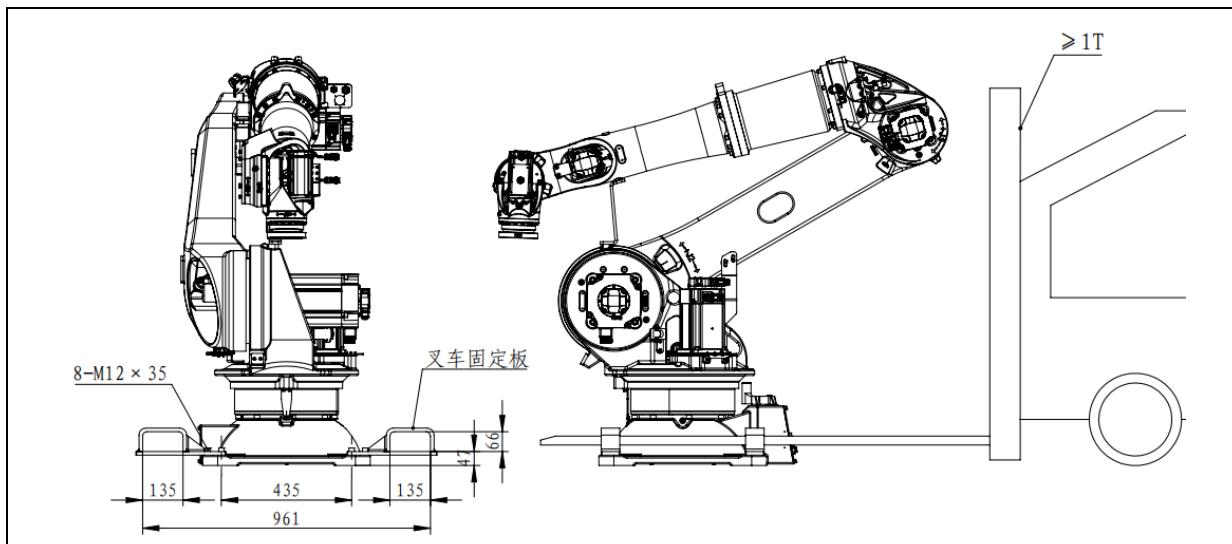
图 1.7 机器人叉车搬运示意图（ER50B-2700）
