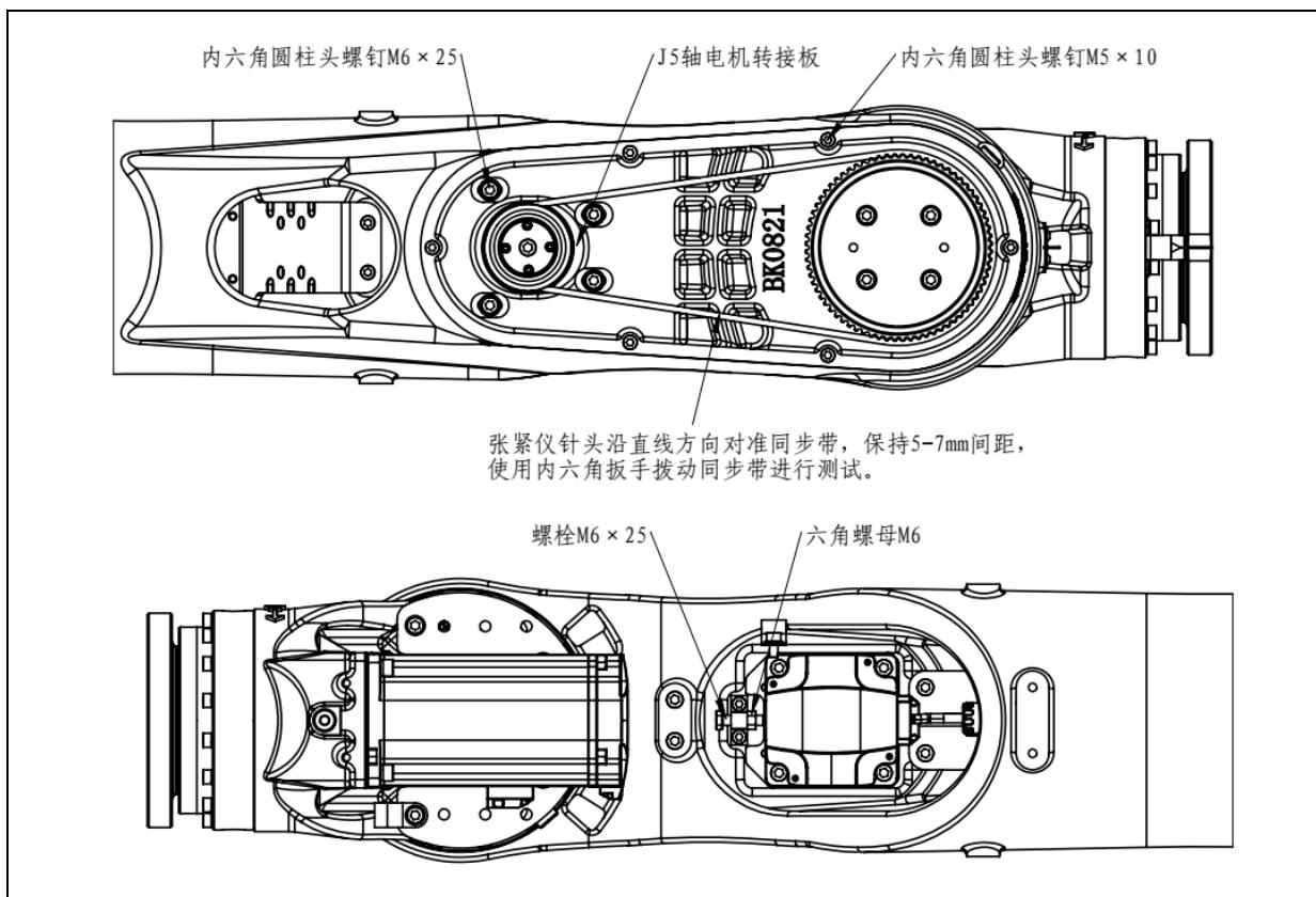
图 5.2 同步带张紧位置示意图 (ER50B-2100、ER50B-2700、ER70B-2100-LI)
