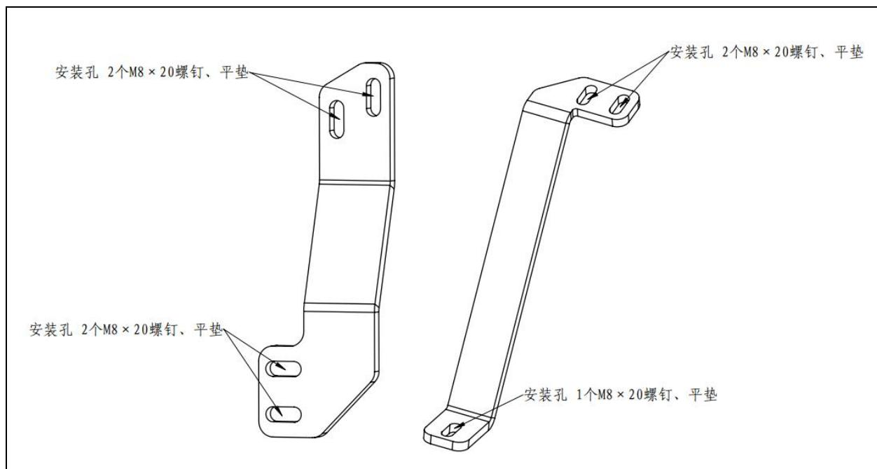
图 1.2 机器人固定支架示意图（ER30B-2700-LI）
