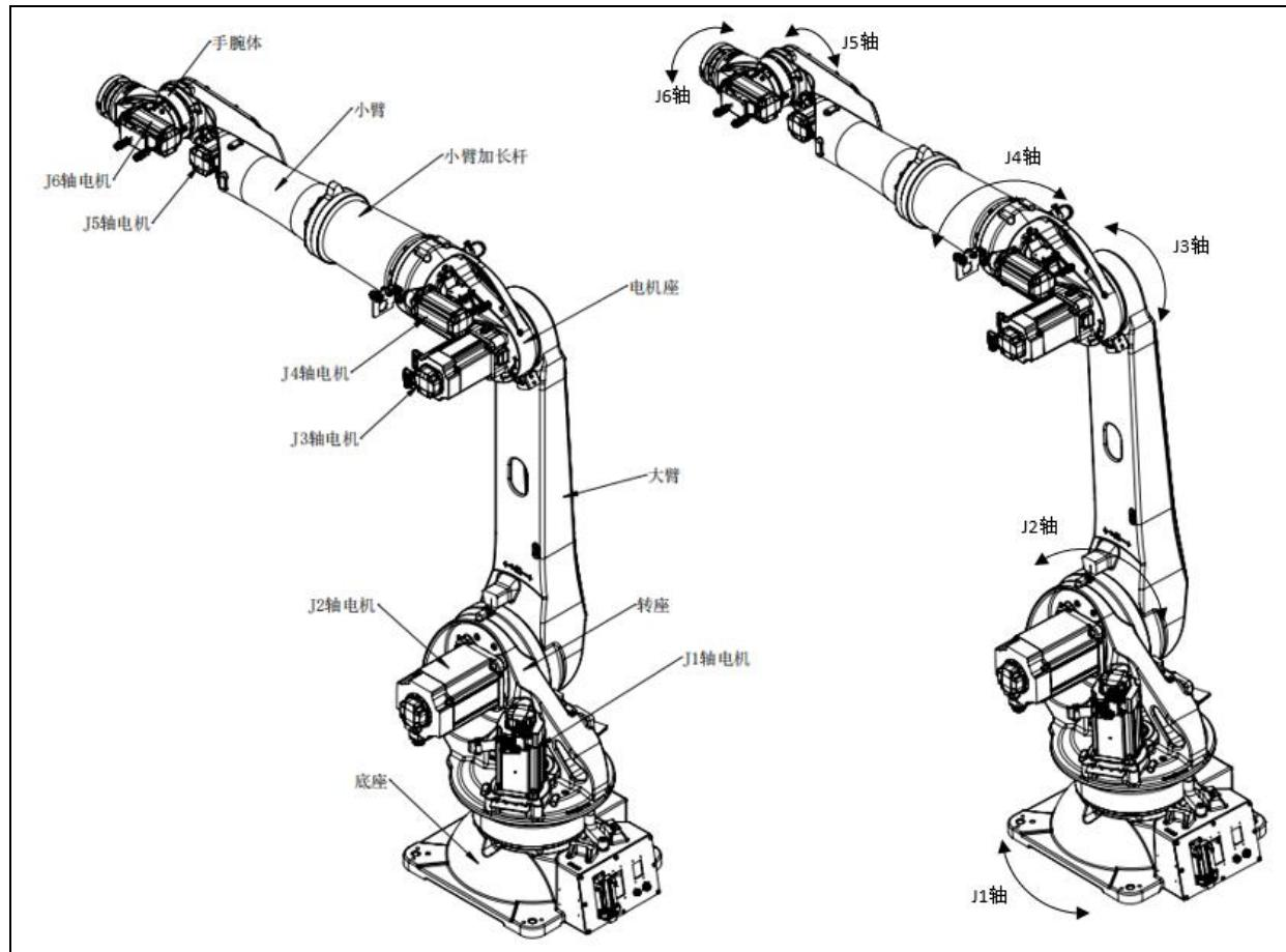
图 3.3 机器人的构成 (ER50B-2700)
