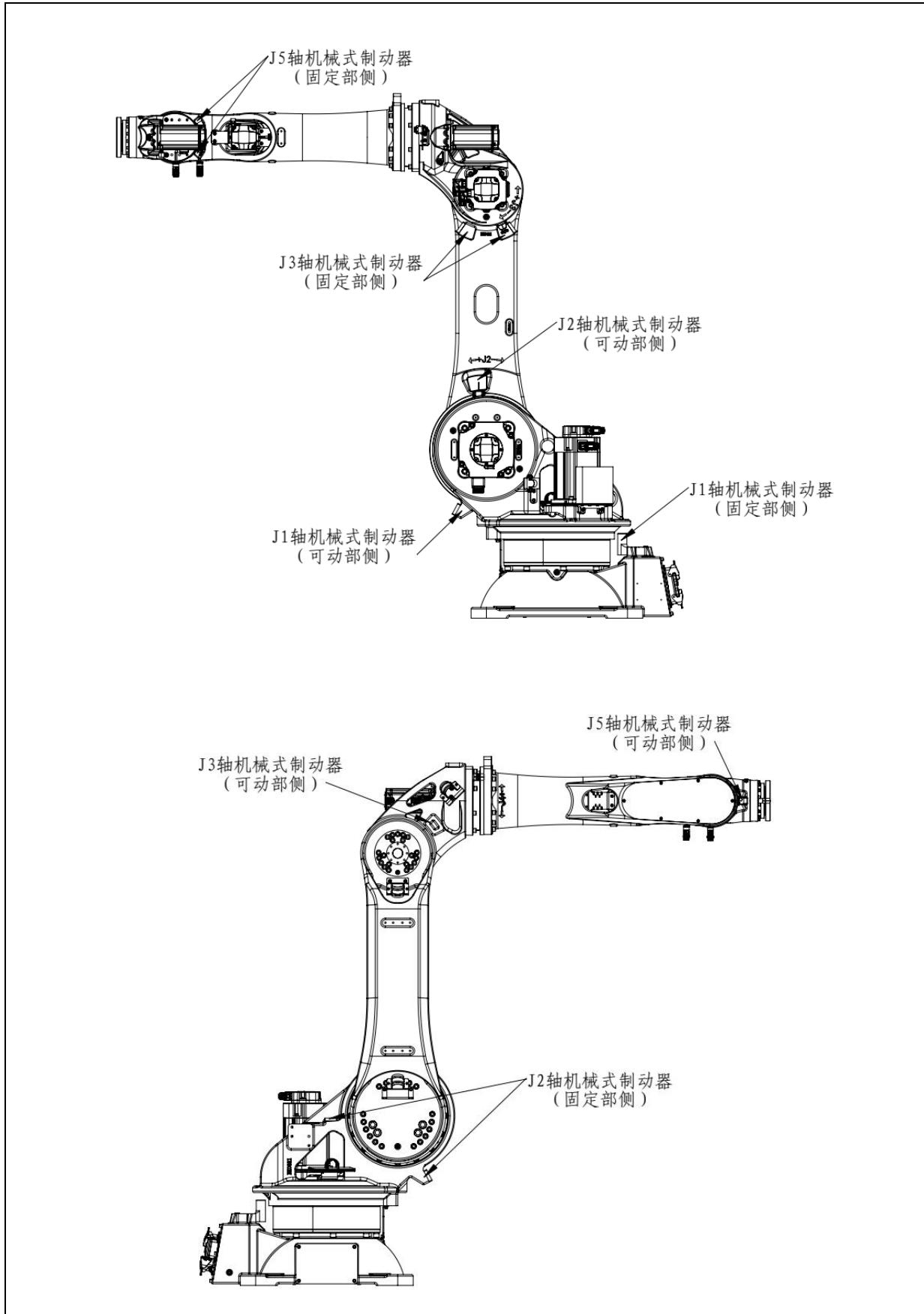
图 3.12 机械式制动器位置 (ER50B-2100、ER70B-2100-LI)
