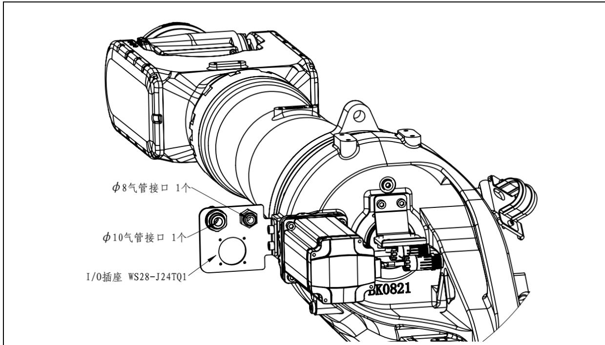
图 4.7 外部管线示意图
