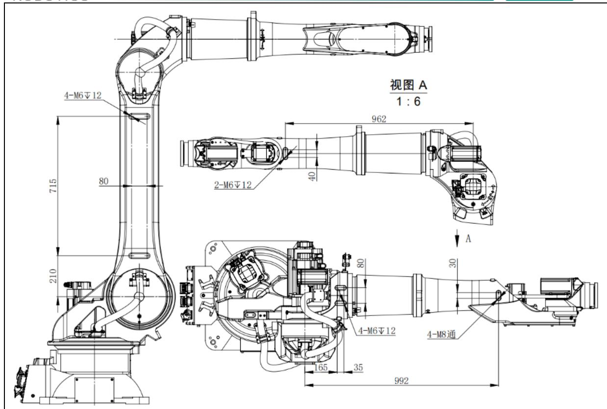
图 4.6 设备安装面尺寸 (ER50B-2700)
