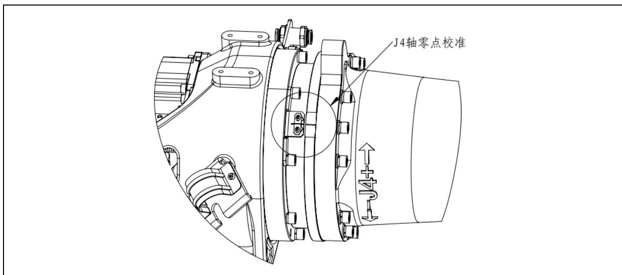
图 6.6 J4 轴校准示意图 (ER20-2300-HI、ER30B-2700-LI、ER50B-2100、ER70B-2100-LI)
