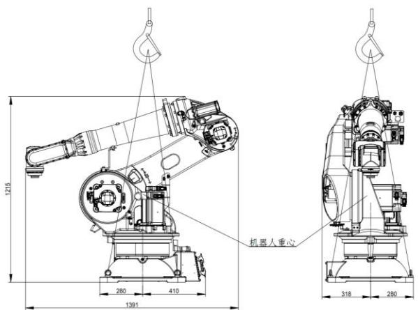
图 1.8 机器人起重机搬运示意图（ER20-2300-HI）
