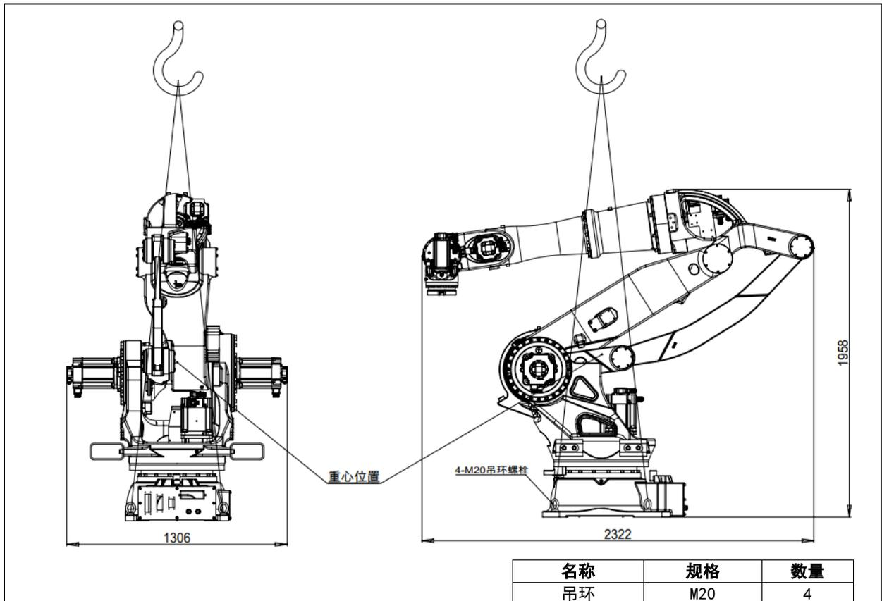
图 1.7 机器人起重机搬运示意图 (ER220-3200,ER280-3200,ER280-3200-LI)
