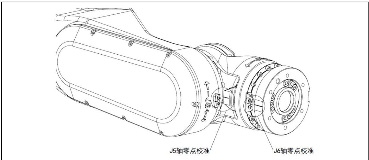
图 6.11 J5、J6 轴零点校准示意图(ER220-3200,ER280-3200, ER280-3200-LI)
