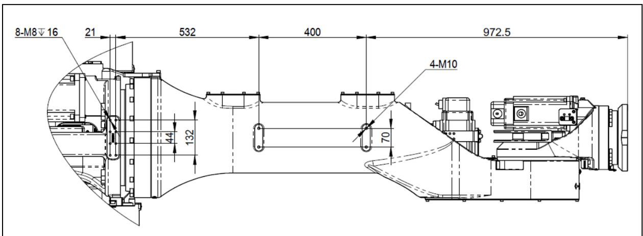
图 4.10 设备安装面尺寸 (ER350-3300)
