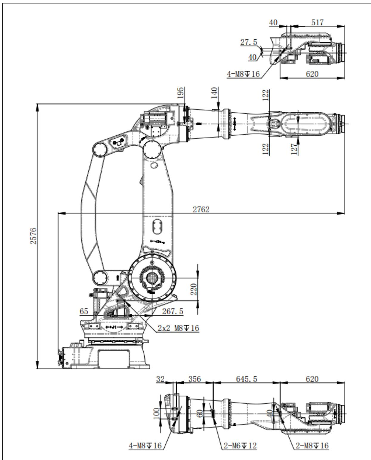
图 4.6 设备安装面尺寸 (ER280-3200-LI)
