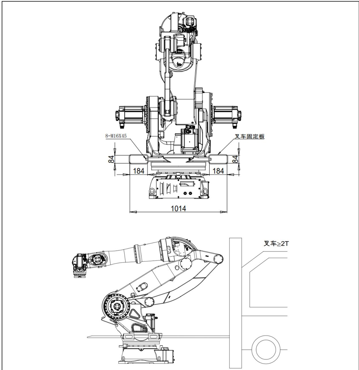
图 1.2 机器人叉车搬运示意图（ER220-3200,ER280-3200,ER280-3200-LI）
