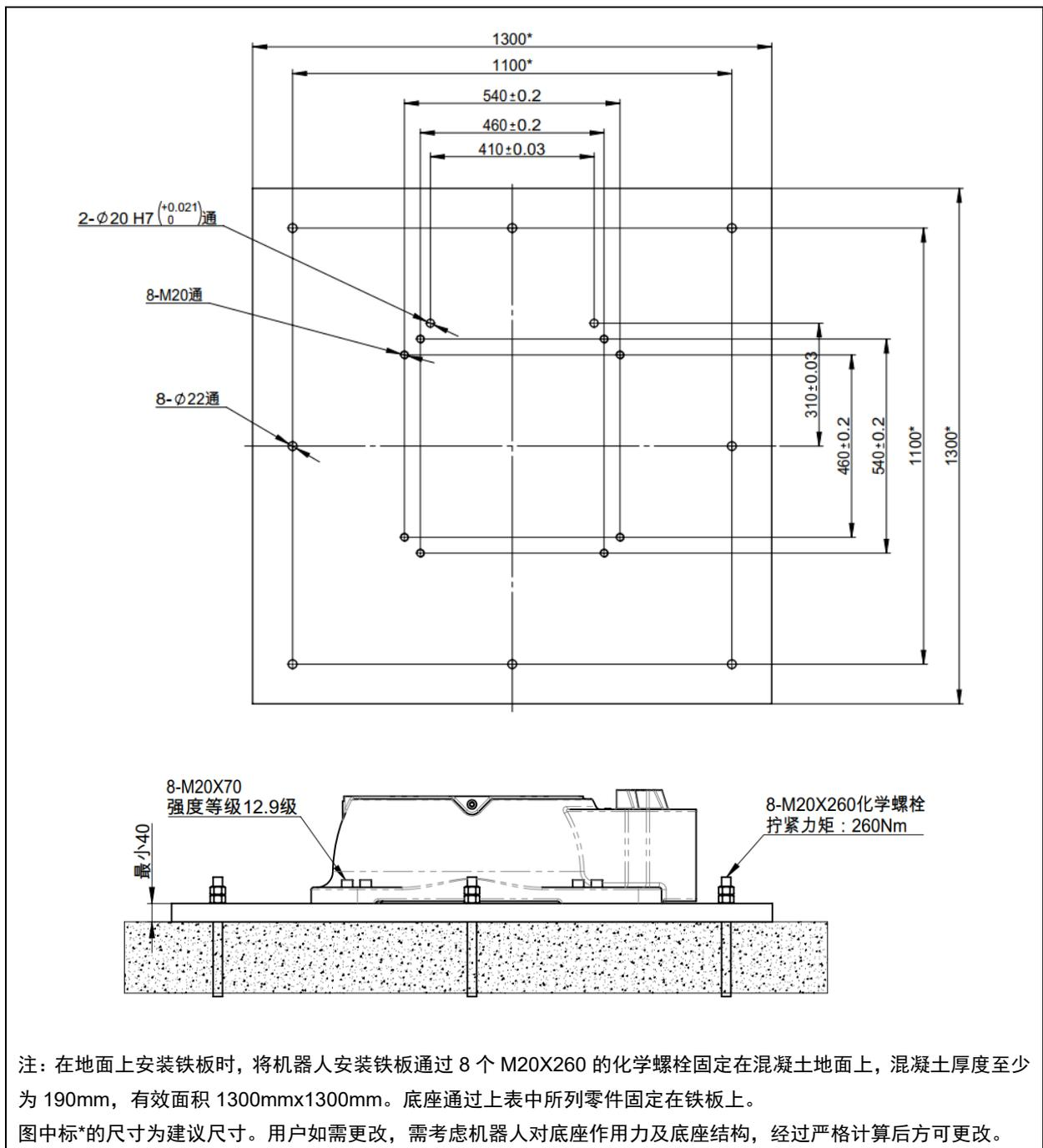
图 1.6 机器人安装铁板尺寸 (ER220-3200, ER280-3200, ER280-3200-LI, ER350-3200)
