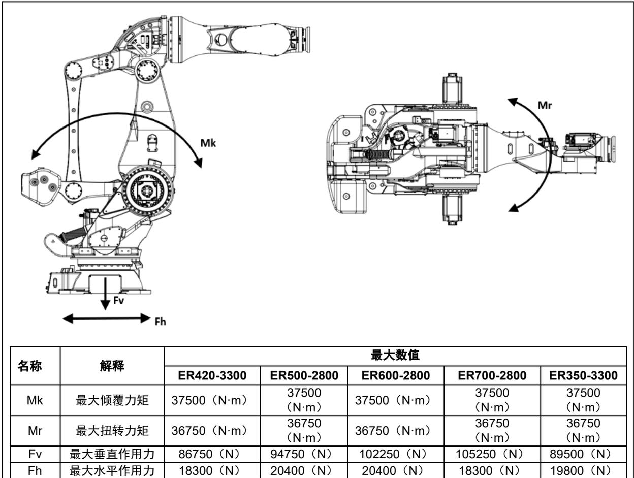
图 1.3 机器人底座受力数据
