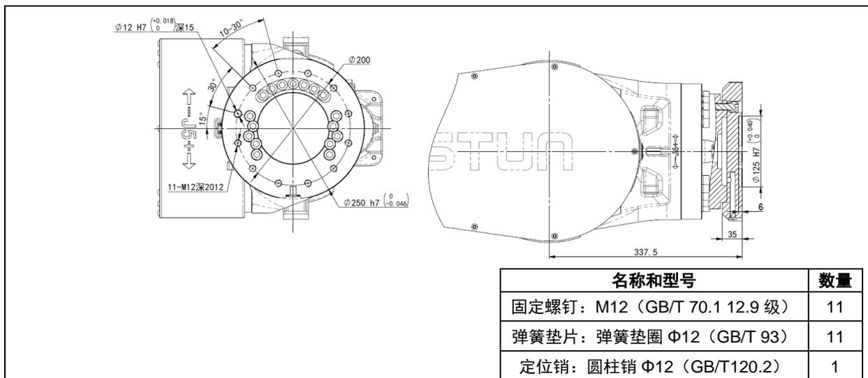
图 4.3 末端法兰安装接口 (ER420-3300)
