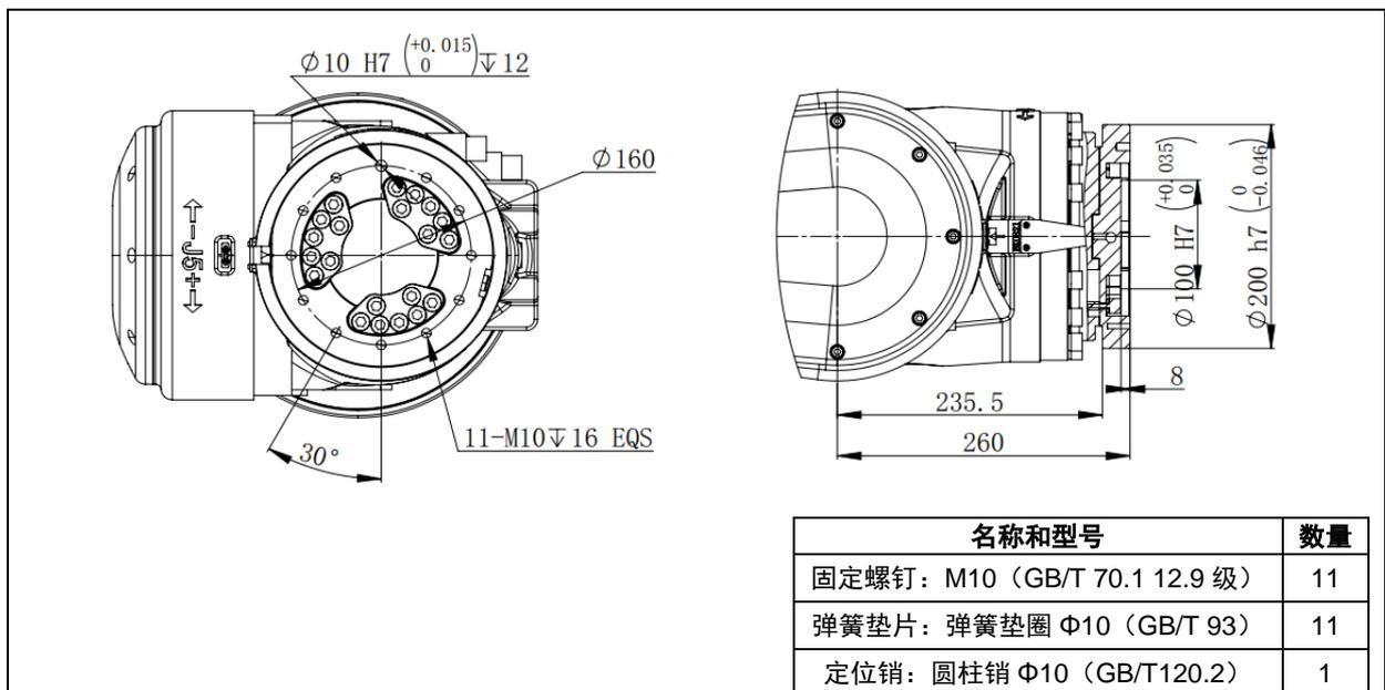
图 4.2 末端法兰安装接口 (ER350-3200)
