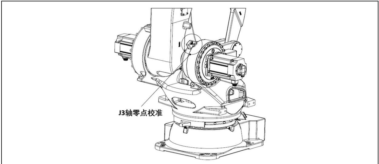
图 6.7 J3 轴零点校准示意图(ER220-3200,ER280-3200, ER280-3200-LI,ER350-3200)
