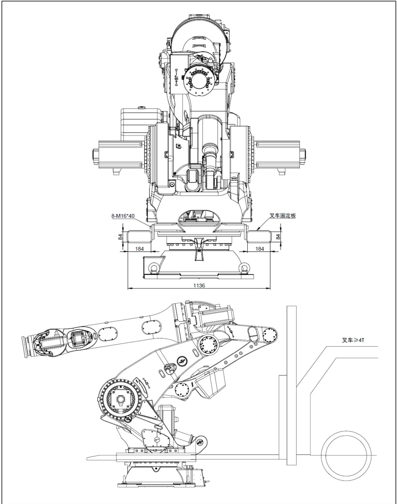
图 1.4 机器人叉车搬运示意图 (ER420-3300)
