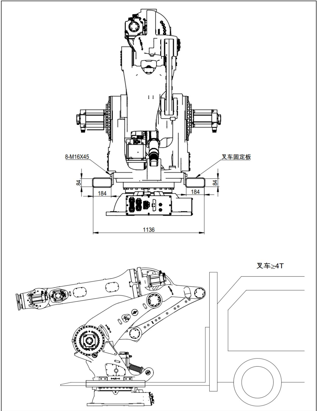
图 1.6 机器人叉车搬运示意图 (ER350-3300)
