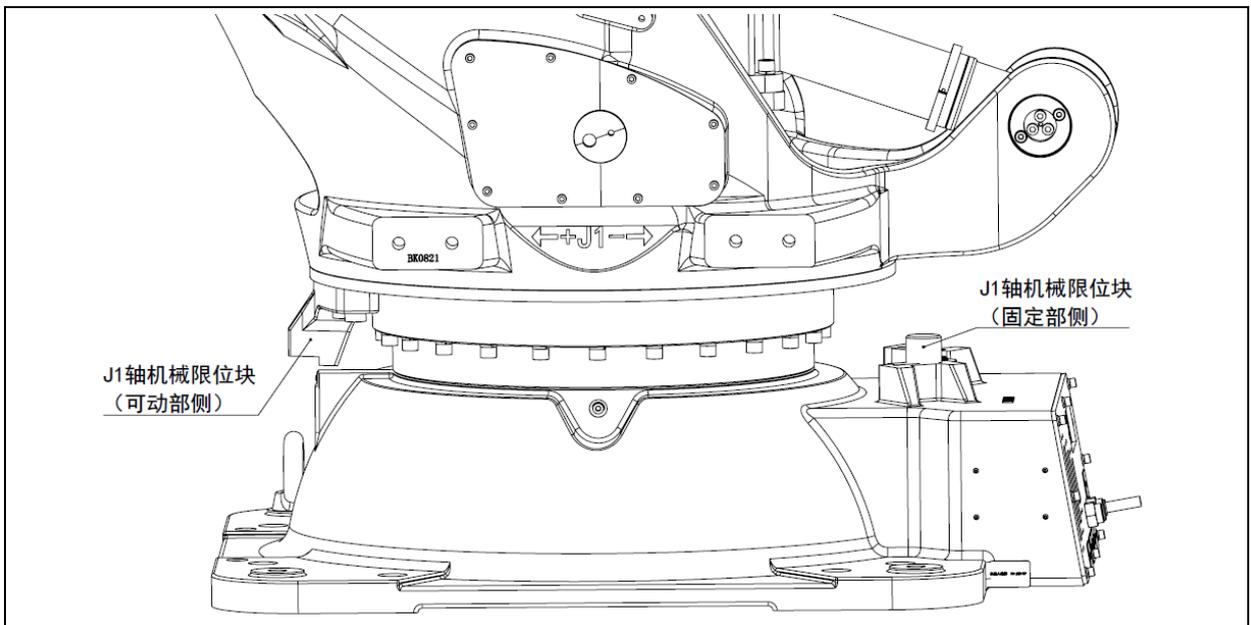
图 3.19 J1 轴机械式制动器位置 (ER350-3300, ER420-3300, ER500-2800, ER600-2800, ER700-2800)
