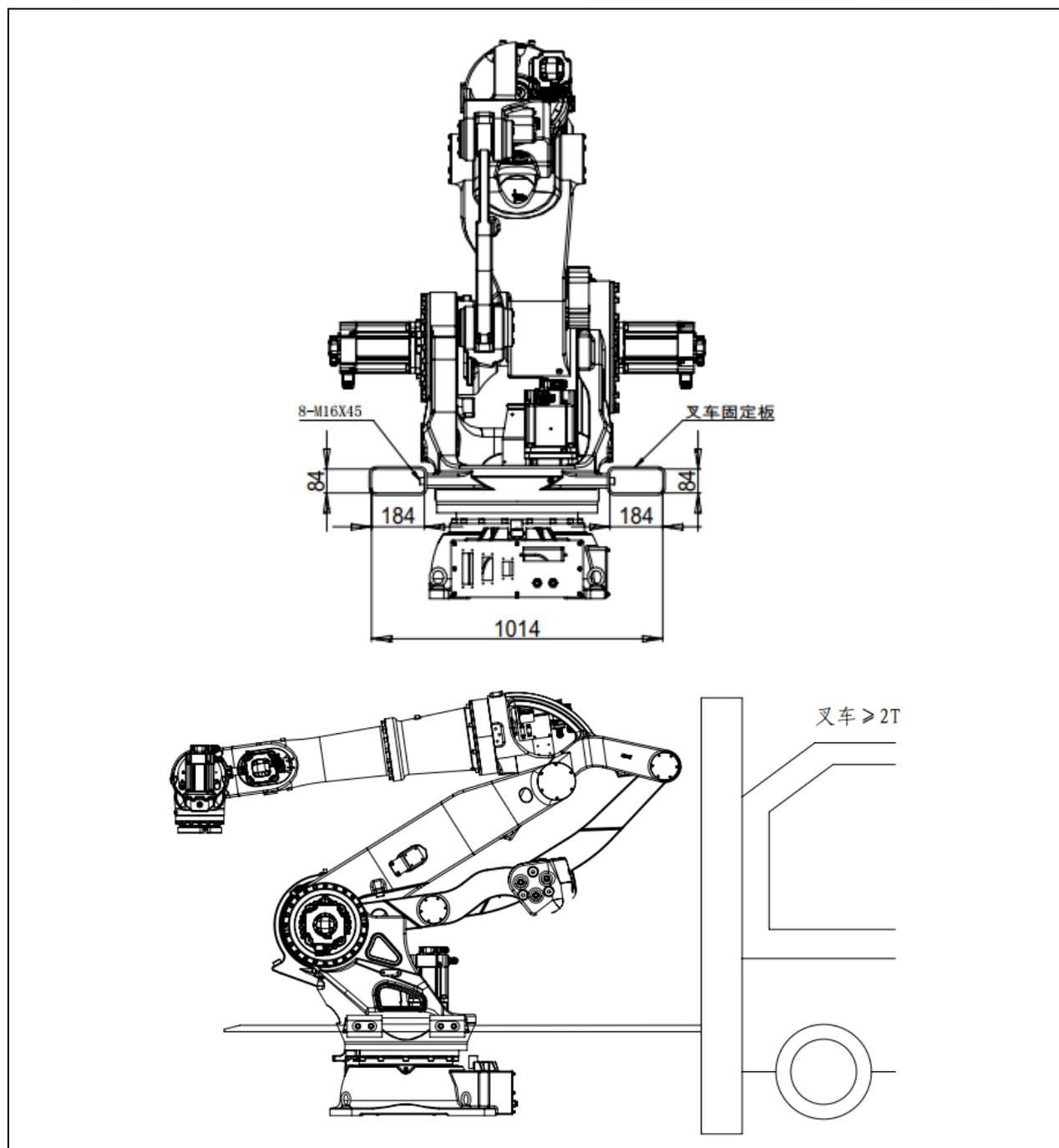
图 1.3 机器人叉车搬运示意图 (ER350-3200)
