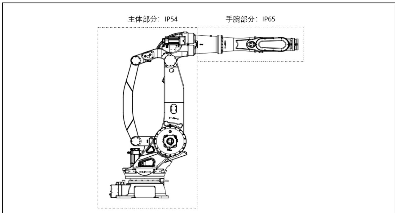
图 1.20 机器人防护等级示意图
