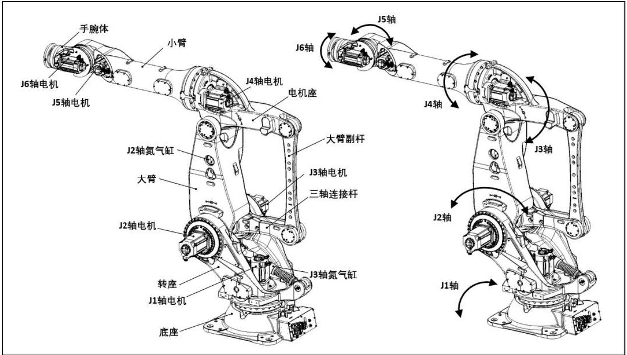
图 3.5 机器人的构成 (ER350-3300)
