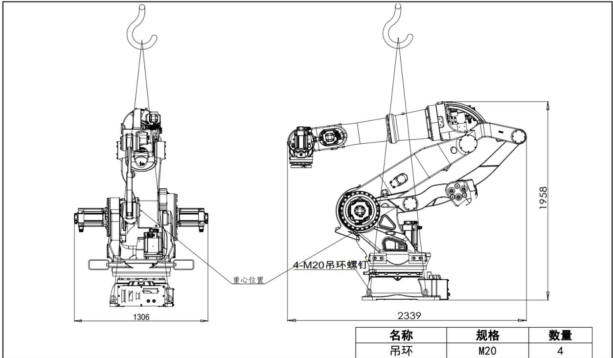
图 1.8 机器人起重机搬运示意图 (ER350-3200)
