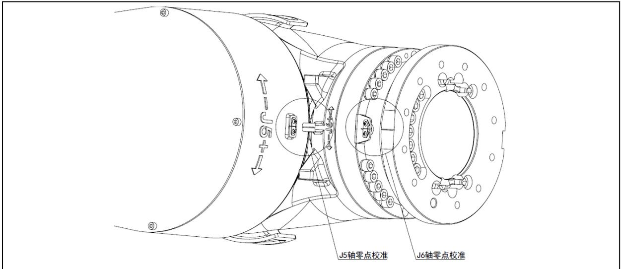
图 6.13 J5、J6 轴零点校准示意图 (ER350-3300, ER420-3300, ER500-2800, ER600-2800, ER700-2800)
