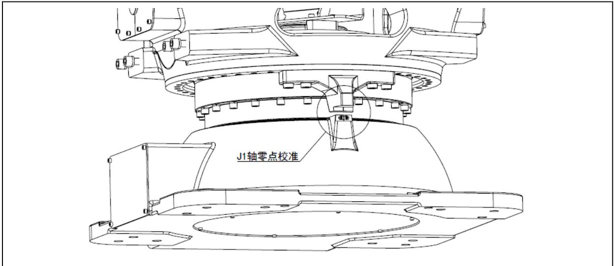
图 6.4 J1 轴零点校准示意图 (ER350-3300, ER420-3300, ER500-2800, ER600-2800, ER700-2800)
