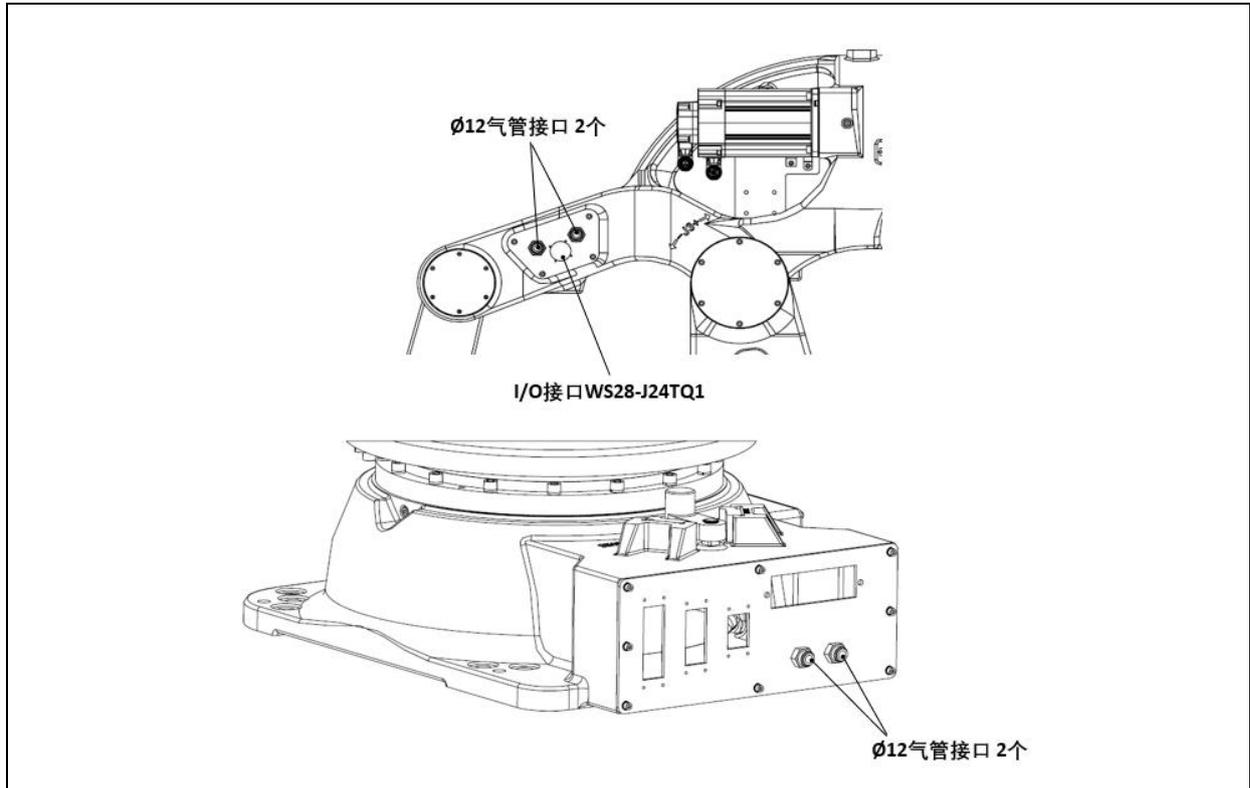
图 4.14 外部管线示意图 (ER220-3200, ER280-3200, ER280-3200-LI, ER350-3200)
