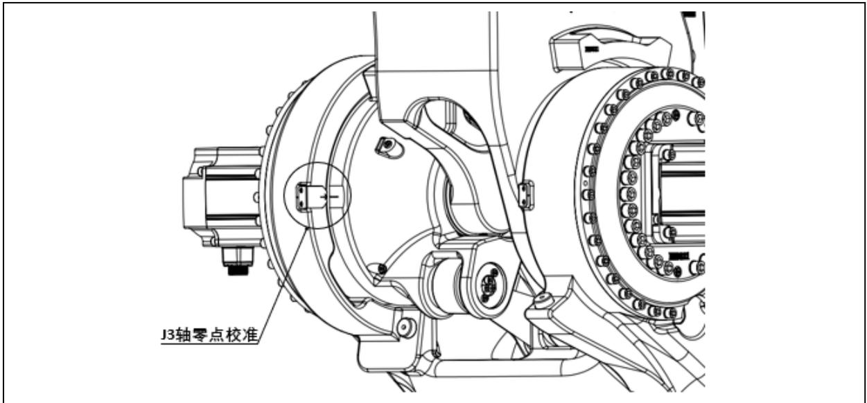
图 6.8 J3 轴零点校准示意图 (ER350-3300, ER420-3300, ER500-2800, ER600-2800, ER700-2800)
