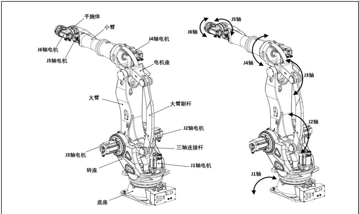
图 3.1 机器人的构成 (ER220-3200,ER280-3200,ER280-3200-LI)
