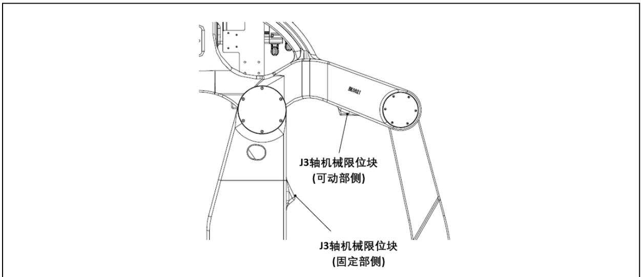
图 3.22 J3 轴机械式制动器位置 (ER220-3200, ER280-3200, ER280-3200-LI, ER350-3200)
