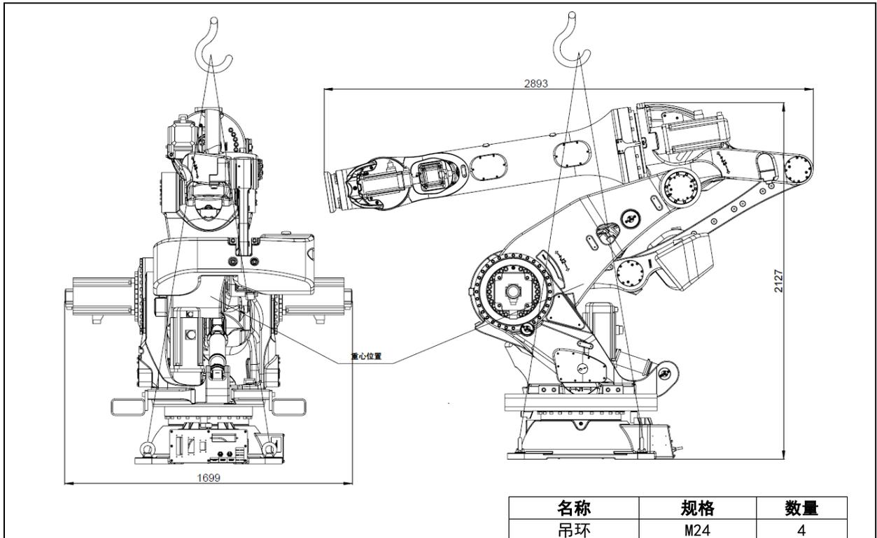
图 1.9 机器人起重机搬运示意图 (ER420-3300)
