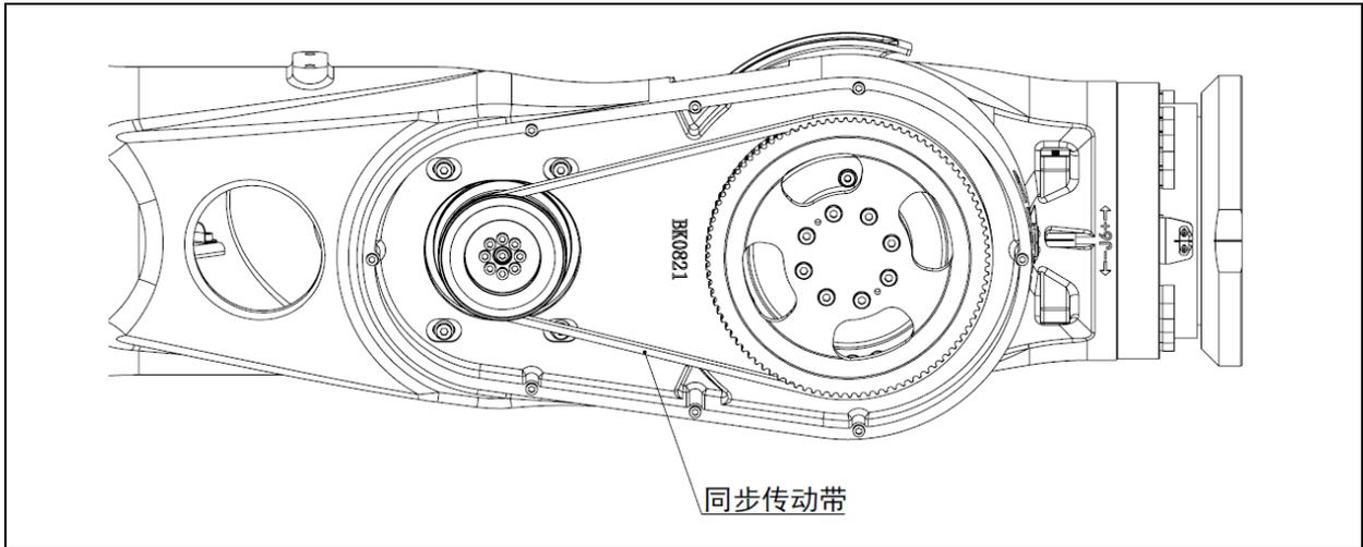
图 5.6 同步带张紧位置示意图 (ER350-3300, ER420-3300, ER500-2800, ER600-2800, ER700-2800)
