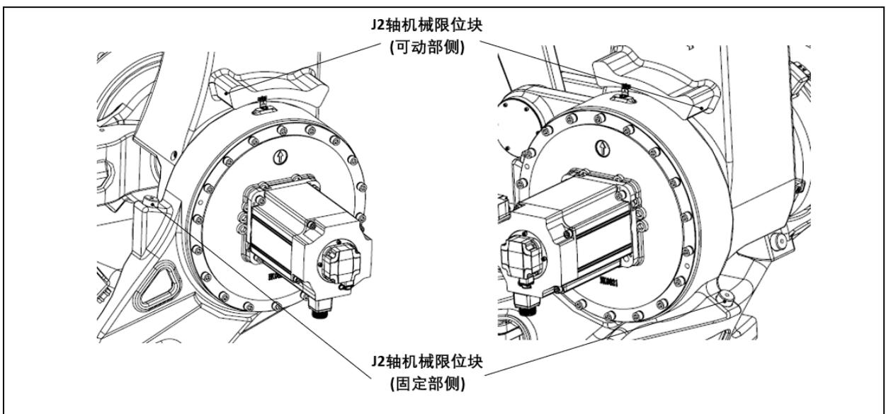
图 3.20 J2 轴机械式制动器位置 (ER220-3200, ER280-3200, ER280-3200-LI, ER350-3200)
