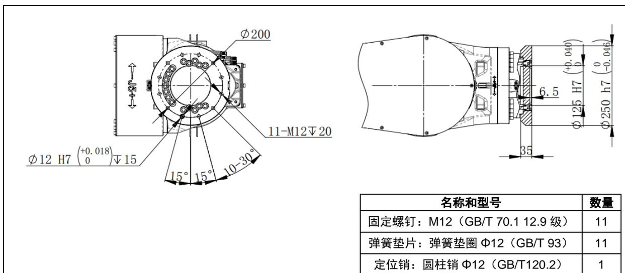
图 4.4 末端法兰安装接口 (ER350-3300,ER500-2800, ER600-2800, ER700-2800)
