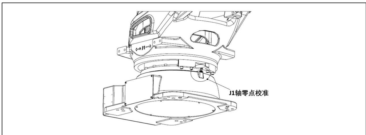
图 6.3 J1 轴零点校准示意图(ER220-3200,ER280-3200, ER280-3200-LI,ER350-3200)
