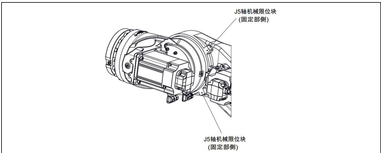
图 3.25 J5 轴机械式制动器位置 (ER350-3200)
