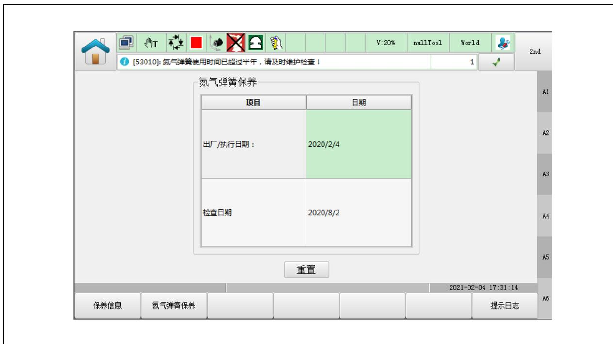
图 5.3 气弹簧检查软件提醒示意图
