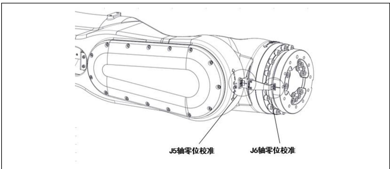
图 6.12 J5、J6 轴零点校准示意图(ER350-3200)
