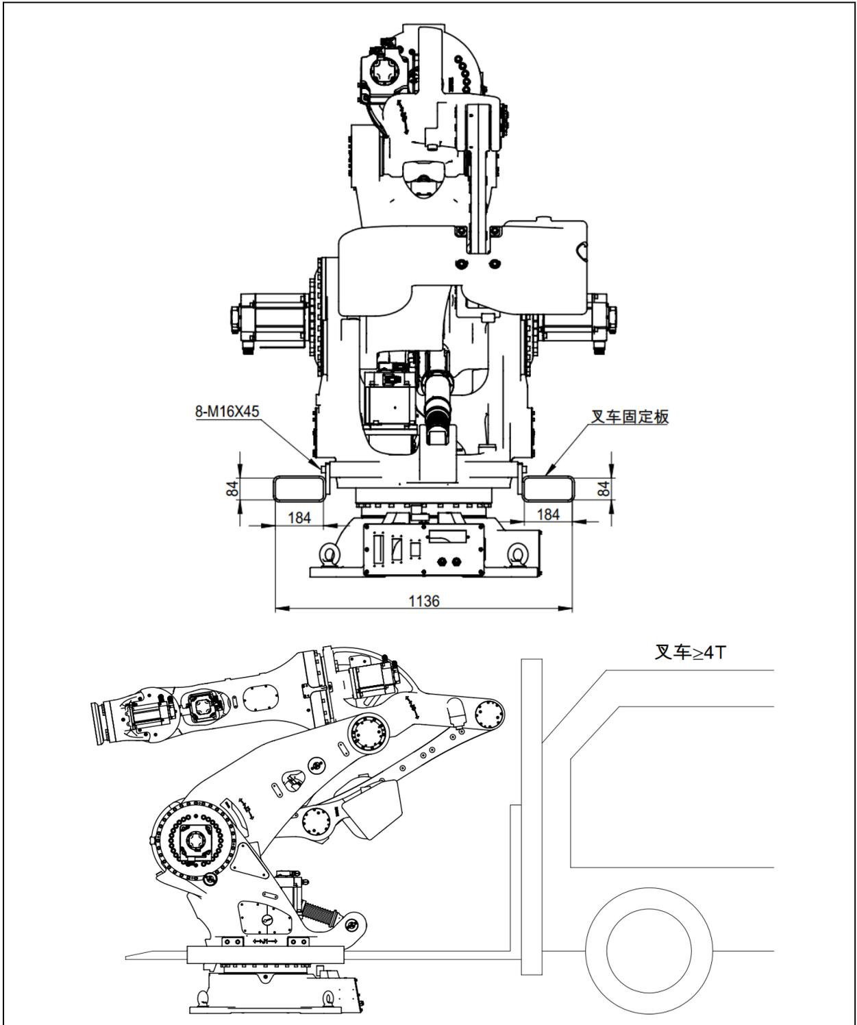
图 1.5 机器人叉车搬运示意图 (ER500-2800,ER600-2800,ER700-2800)
