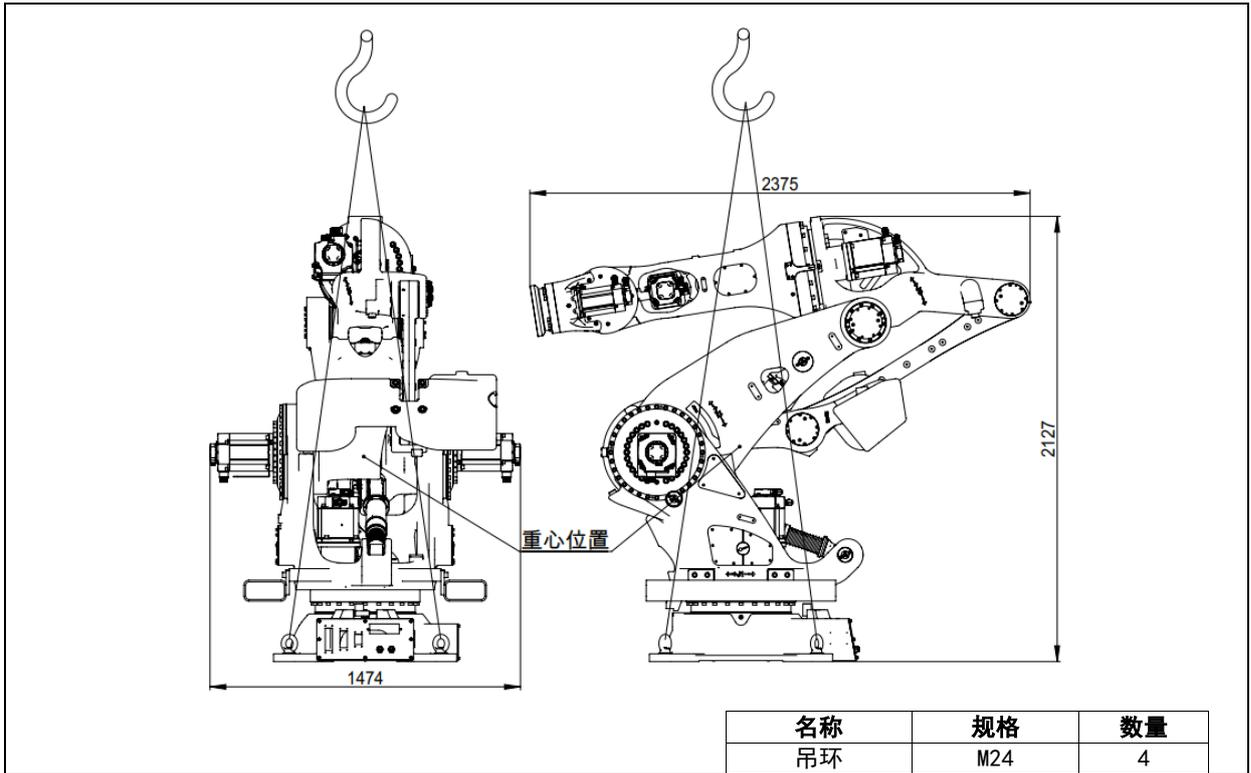
图 1.10 机器人起重机搬运示意图 (ER500-2800, ER600-2800, ER700-2800)
