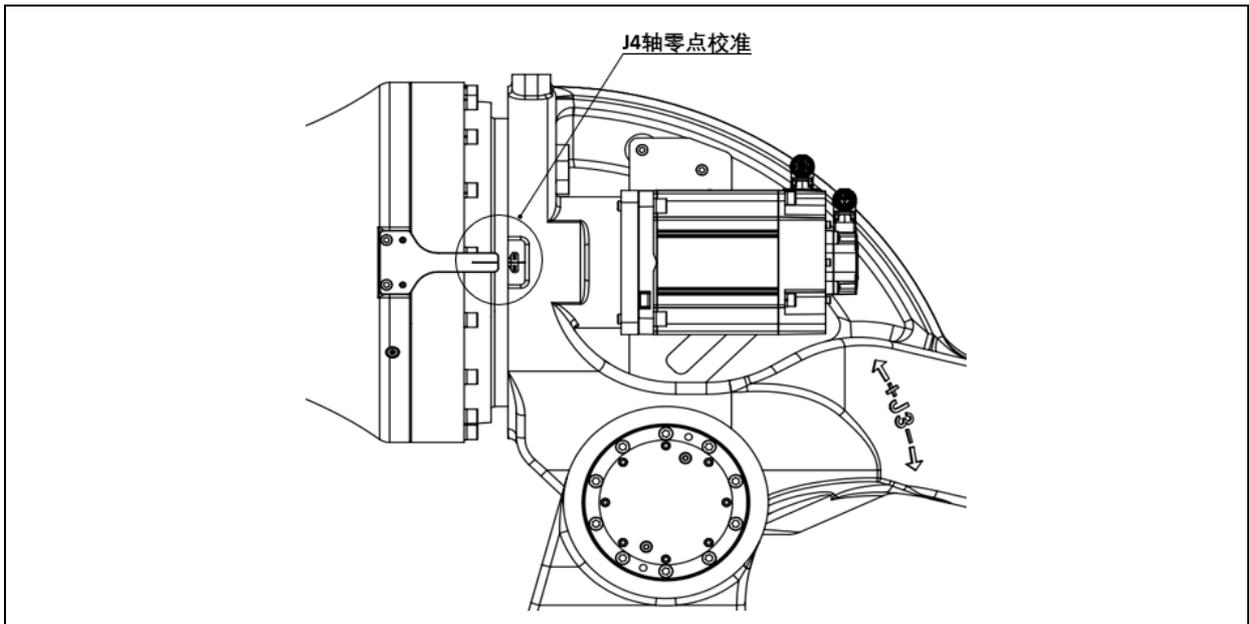
图 6.10 J4 轴零点校准示意图 (ER350-3300, ER420-3300, ER500-2800, ER600-2800, ER700-2800)
