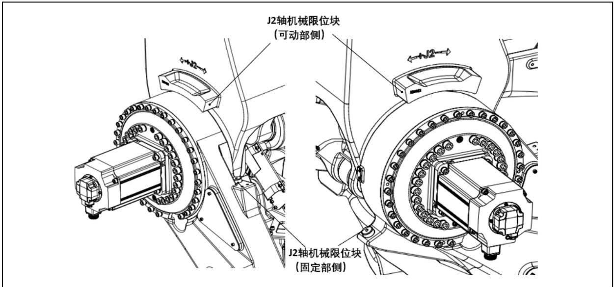
图 3.21 J2 轴机械式制动器位置 (ER350-3300, ER420-3300, ER500-2800, ER600-2800, ER700-2800)
