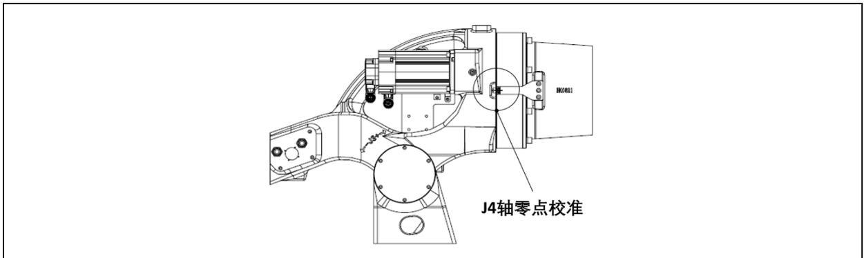
图 6.9 J4 轴零点校准示意图(ER220-3200,ER280-3200, ER280-3200-LI,ER350-3200)
