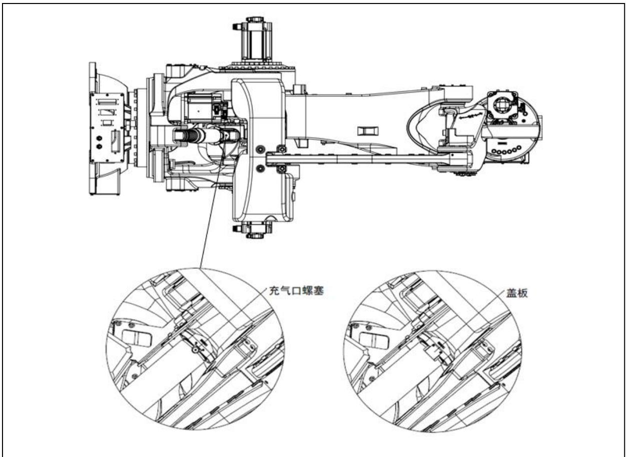
图 5.2 气弹簧检查示意图（ER350-3300, ER500-2800, ER600-2800, ER700-2800）
