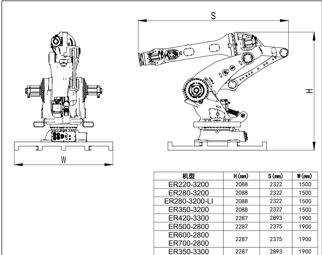
图 1.12 机器人存储空间尺寸图
