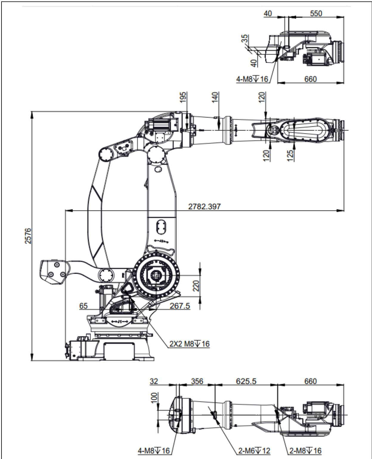
图 4.7 设备安装面尺寸 (ER350-3200)
