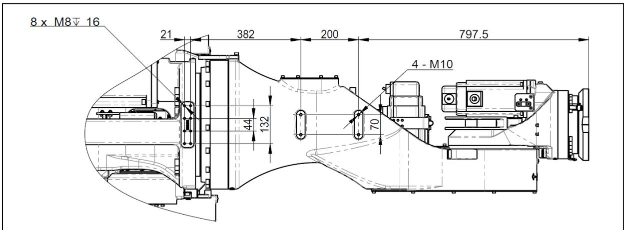
图 4.9 设备安装面尺寸 (ER500-2800, ER600-2800, ER700-2800)
