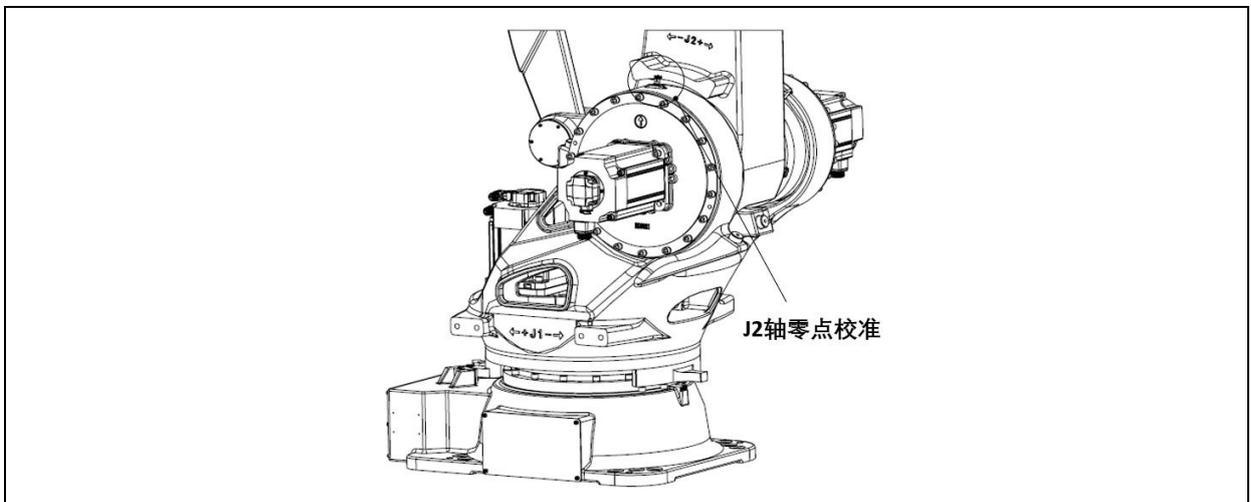
图 6.5 J2 轴零点校准示意图(ER220-3200,ER280-3200, ER280-3200-LI,ER350-3200)
