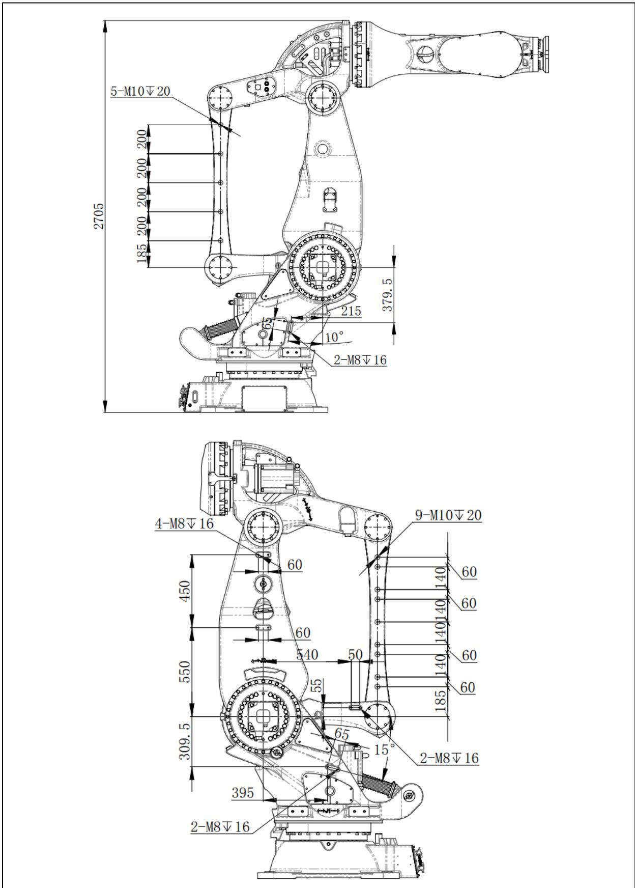
图 4.12 设备安装面尺寸 (ER350-3300,ER500-2800)
