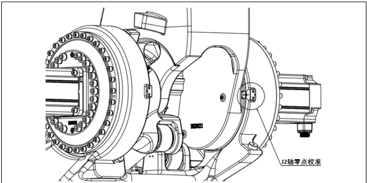
图 6.6 J2 轴零点校准示意图 (ER350-3300, ER420-3300, ER500-2800, ER600-2800, ER700-2800)
