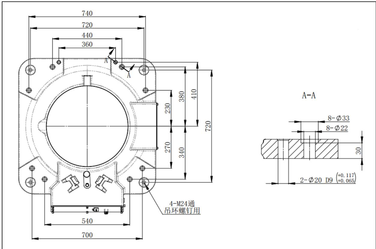
图 1.5 机器人底座安装尺寸 (ER350-3300, ER420-3300, ER500-2800, ER600-2800, ER700-2800)
