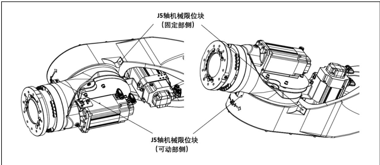
图 3.26 J5 轴机械式制动器位置 (ER350-3300, ER420-3300, ER500-2800, ER600-2800, ER700-2800)
