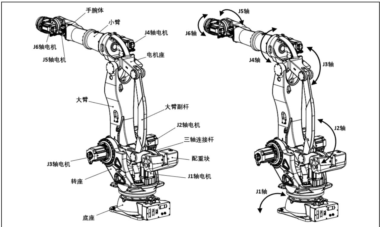
图 3.2 机器人的构成 (ER350-3200)
