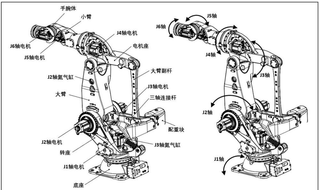
图 3.4 机器人的构成 (ER600-2800, ER700-2800, ER500-2800 无配重块)
