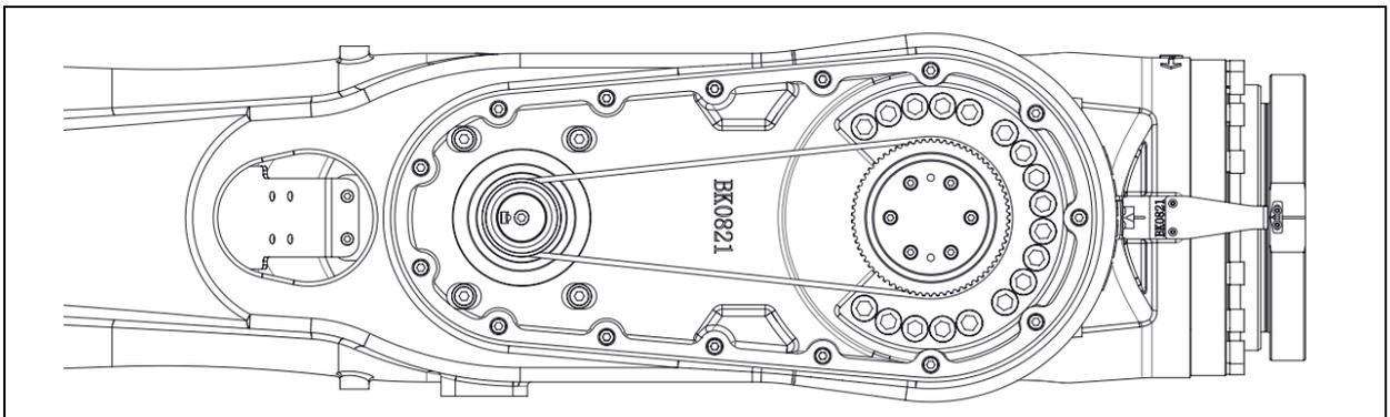
图 5.5 同步带张紧位置示意图（ER350-3200）
