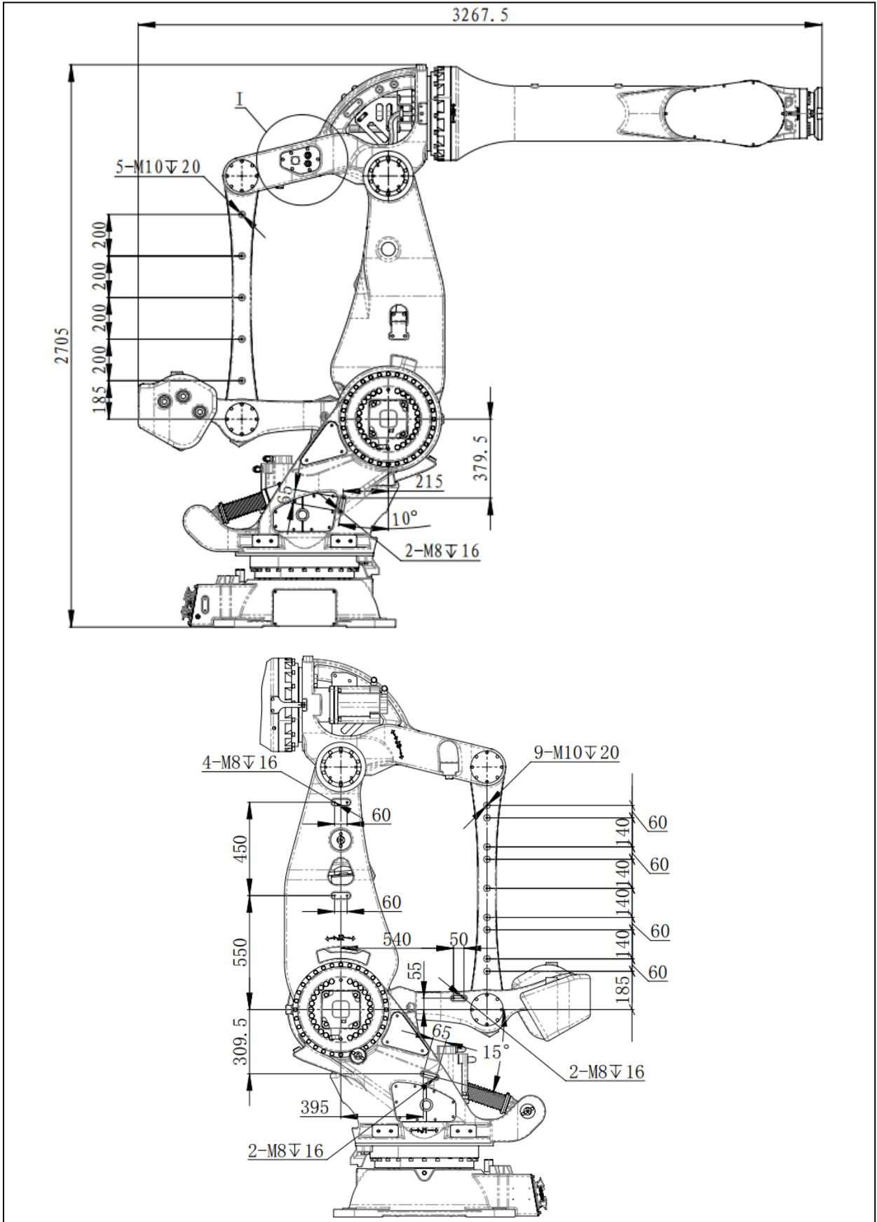
图 4.11 设备安装面尺寸 (ER420-3300)
