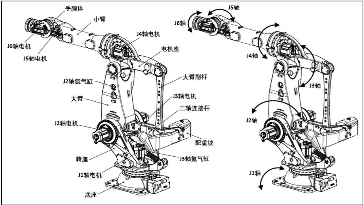
图 3.3 机器人的构成 (ER420-3300)
