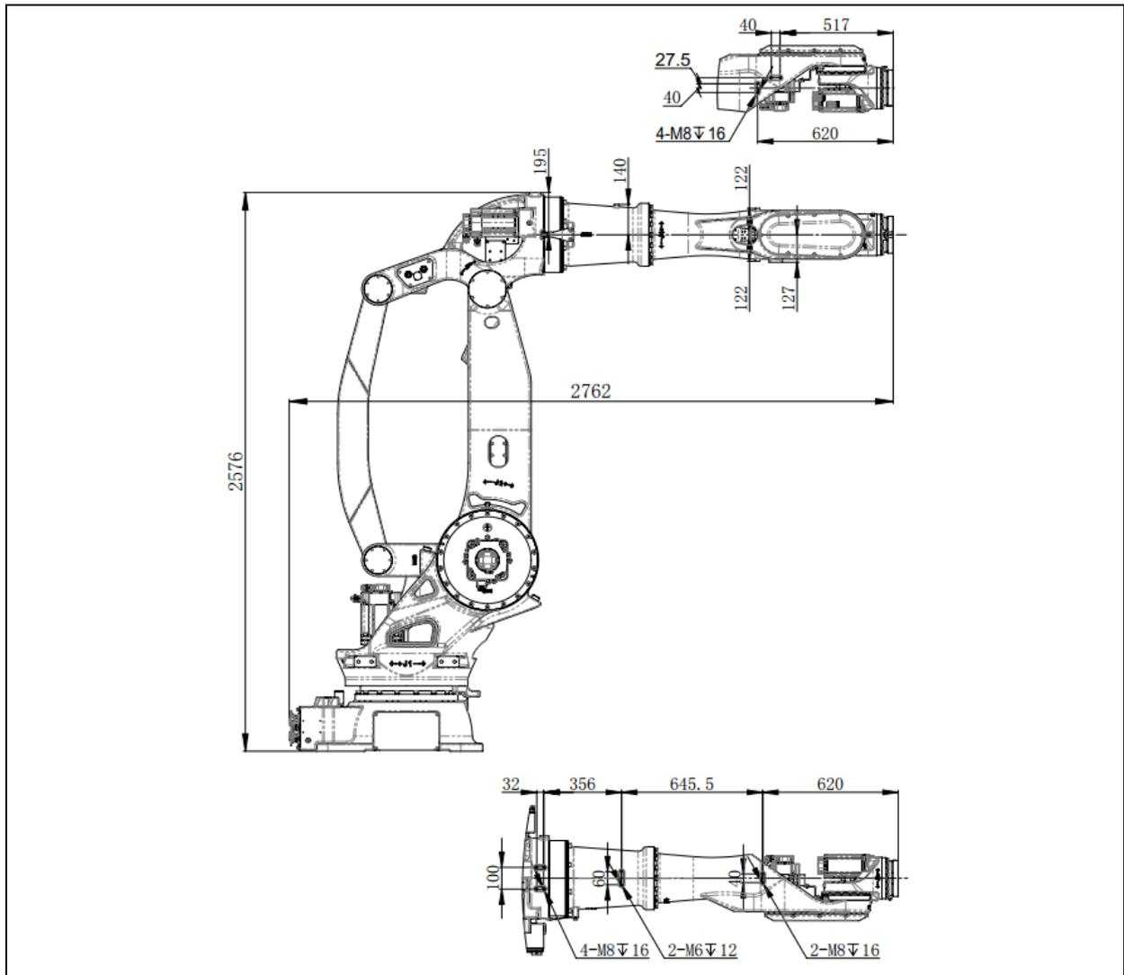
图 4.5 设备安装面尺寸 (ER220-3200,ER280-3200)
