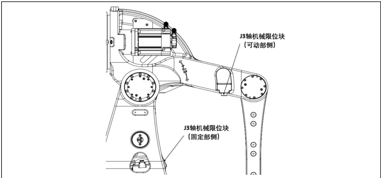
图 3.23 J3 轴机械式制动器位置 (ER350-3300, ER420-3300, ER500-2800, ER600-2800, ER700-2800)
