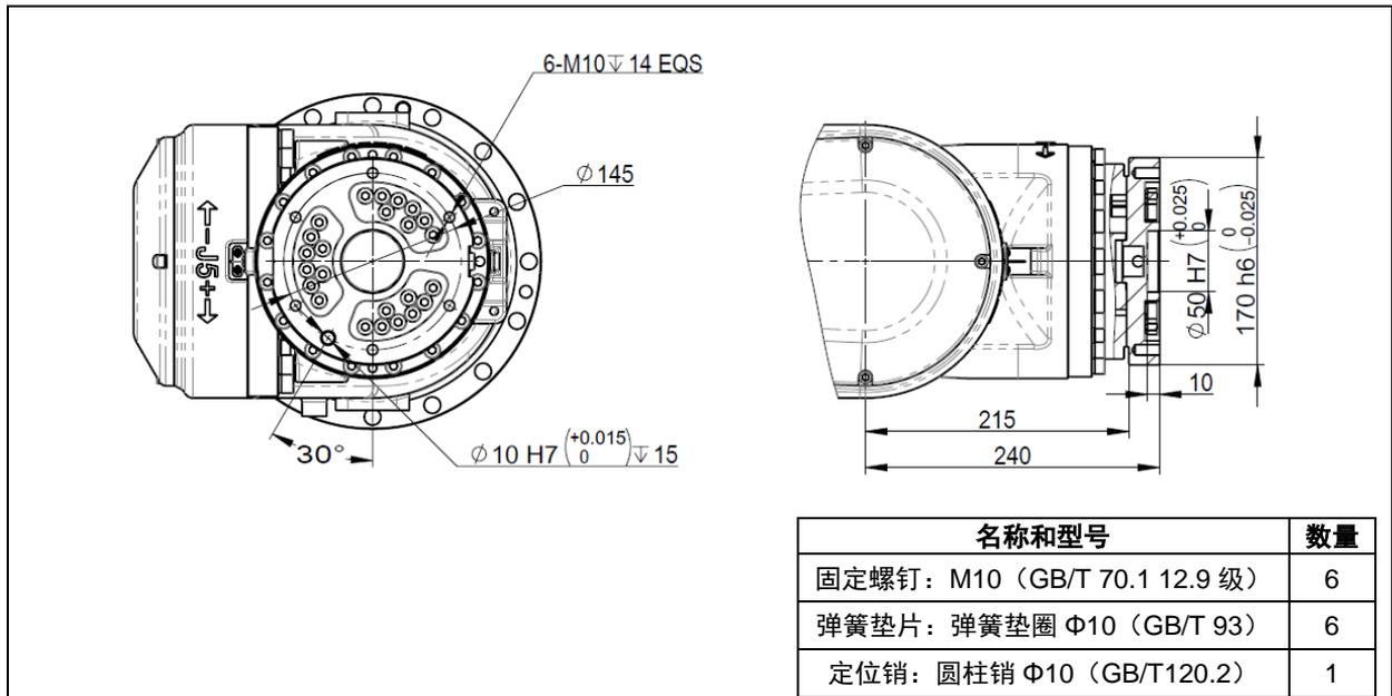
图 4.1 末端法兰安装接口 (ER220-3200, ER280-3200, ER280-3200-LI)
