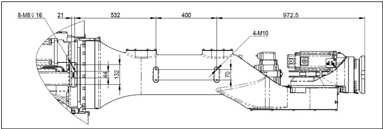
图 4.8 设备安装面尺寸 (ER420-3300)
