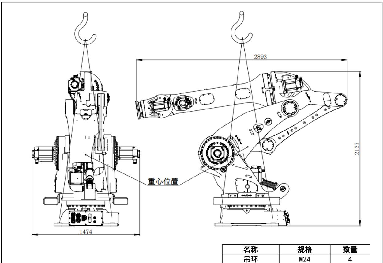
图 1.11 机器人起重机搬运示意图 (ER350-3300)
