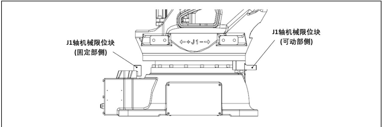
图 3.2 J1 轴机械式制动器位置 (ER220-3200, ER280-3200, ER280-3200-LI, ER350-3200)
