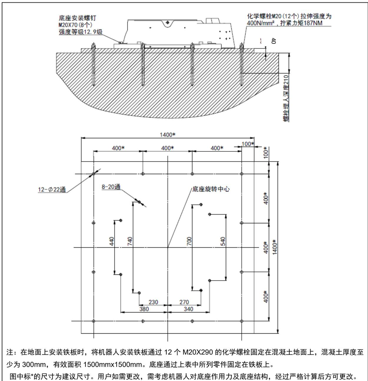
图 1.7 机器人安装铁板尺寸 (ER350-3300, ER420-3300, ER500-2800, ER600-2800, ER700-2800)
