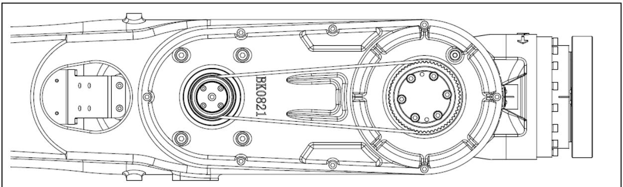
图 5.4 同步带张紧位置示意图（ER220-3200,ER280-3200, ER280-3200-LI）
