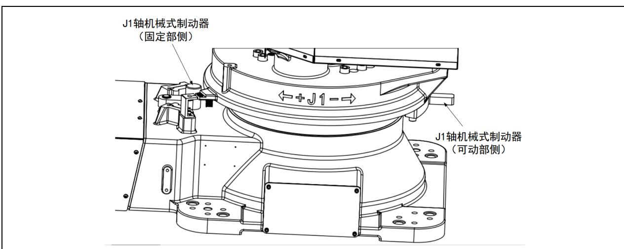
图 3.5 J1 轴机械式制动器位置
