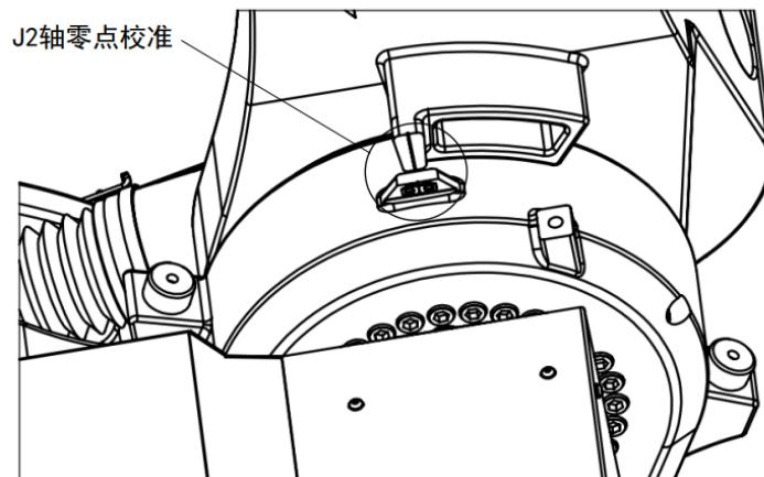
图 6.3 J2 轴校准示意图
