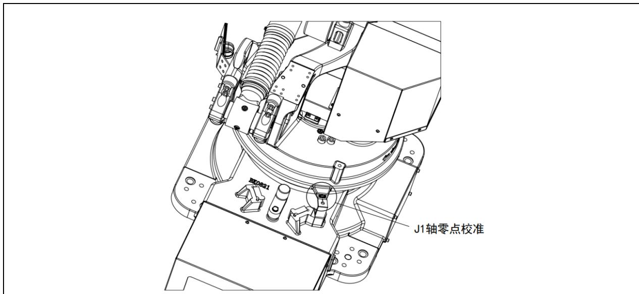
图 6.2 J1 轴零点校准示意图
