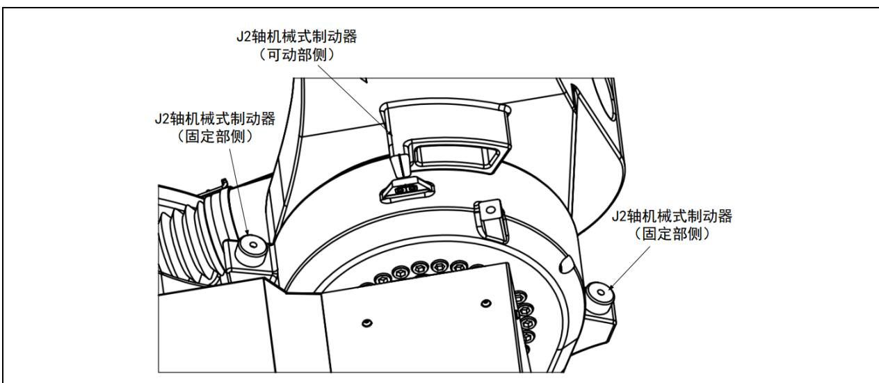
图 3.6 J2 轴机械式制动器位置
