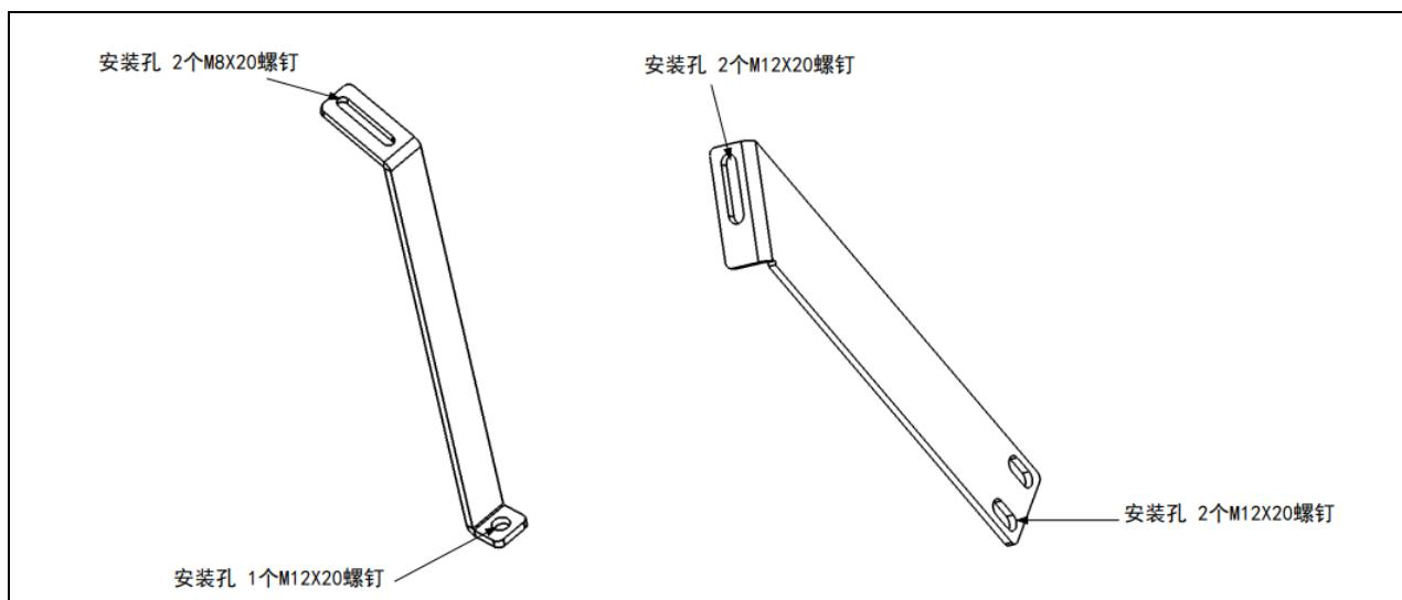
图 1.1 机器人固定支架示意图
