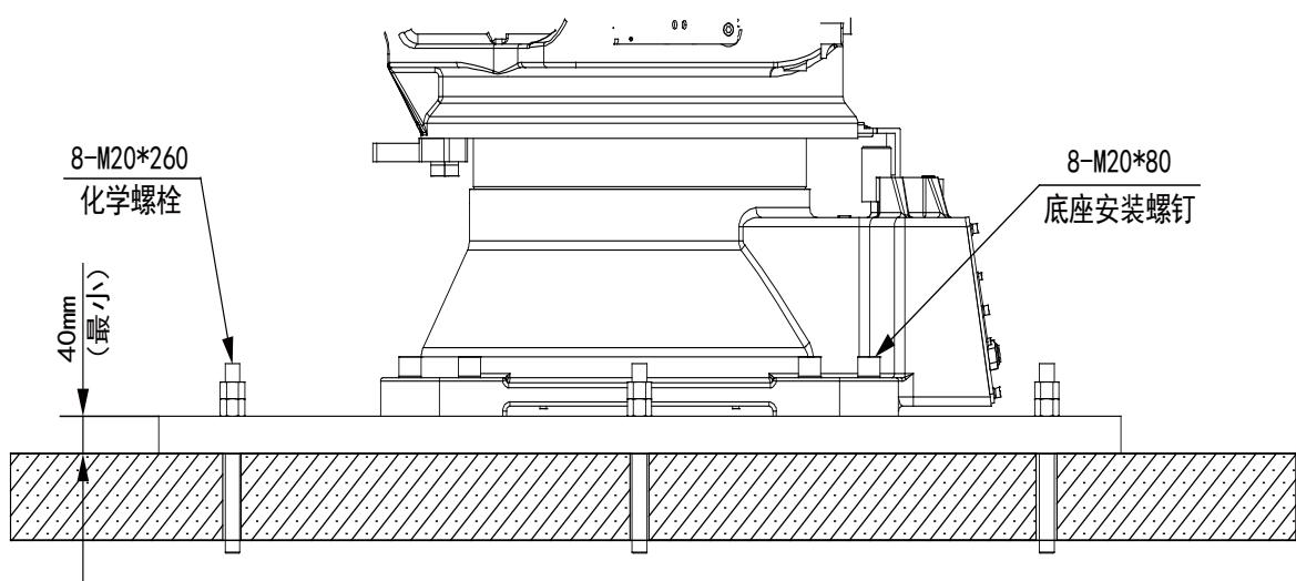
注:在地面上安装铁板时,将机器人安装铁板通过8个M20X260的化学螺栓固定在混凝土地面上,混凝土厚度至少为190mm,有效面积1300mmx1300mm。底座通过上表中所列零件固定在铁板上。
