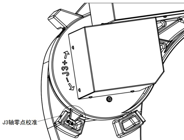
图 6.4 J3 轴校准示意图
