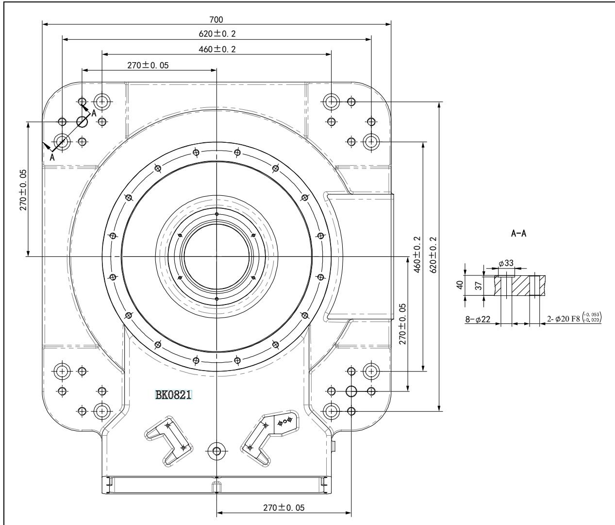
图 1.5 机器人底座安装尺寸
