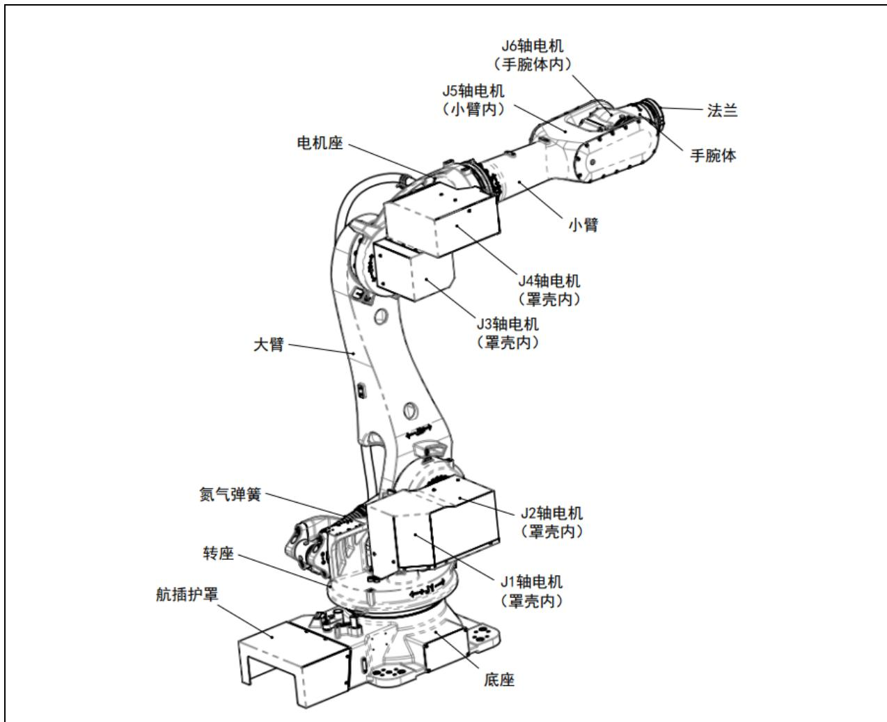
图 3.1 机器人的构成 1
