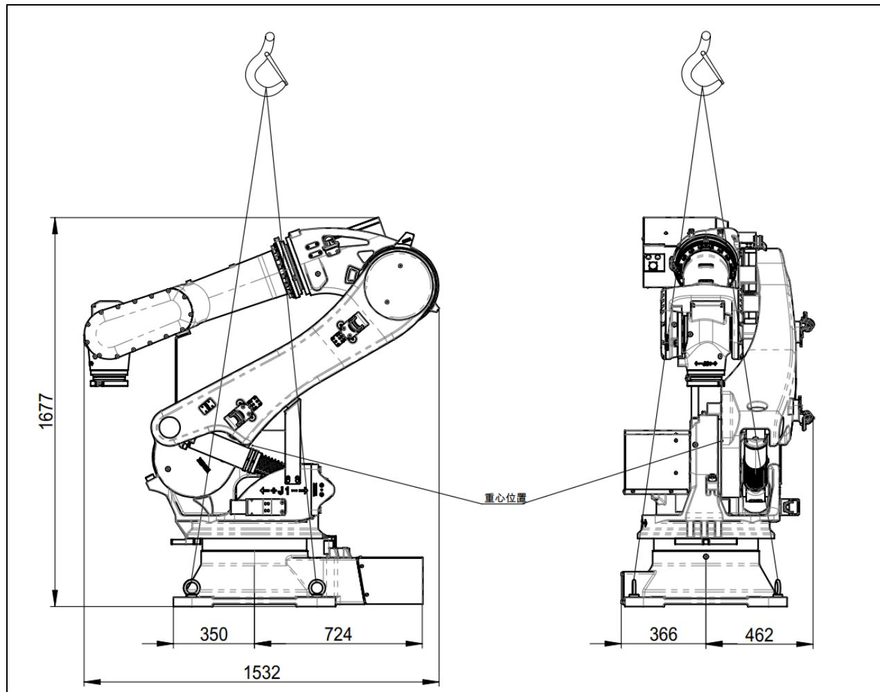
图 1.3 机器人起重机搬运示意图
