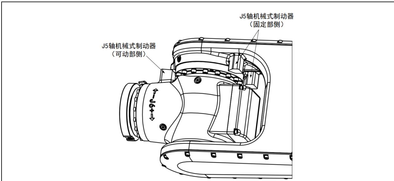
图 3.8 J5 轴机械式制动器位置
