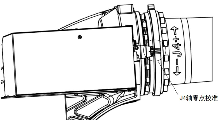
图 6.5 J4 轴校准示意图
