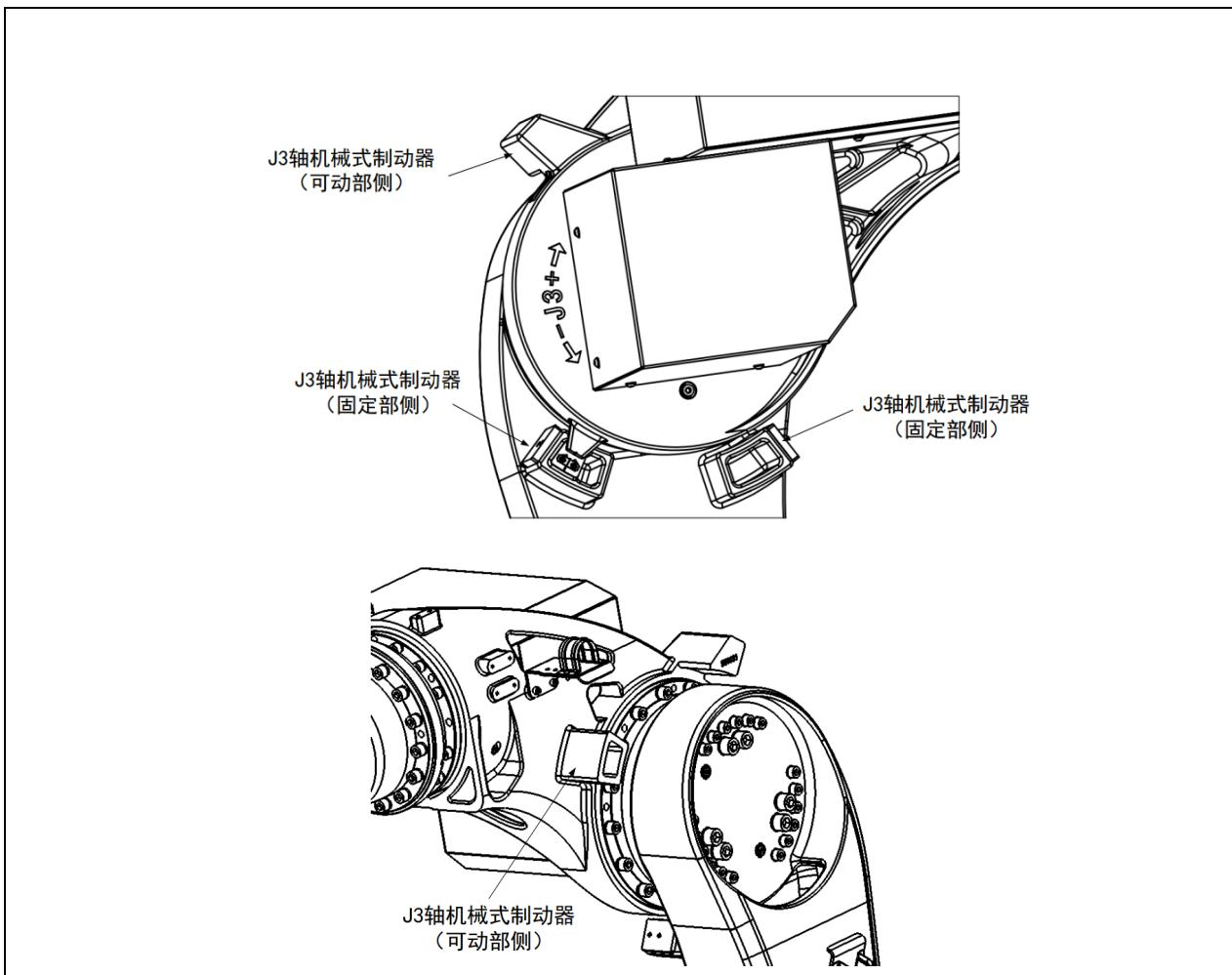
图 3.7 J3 轴机械式制动器位置
