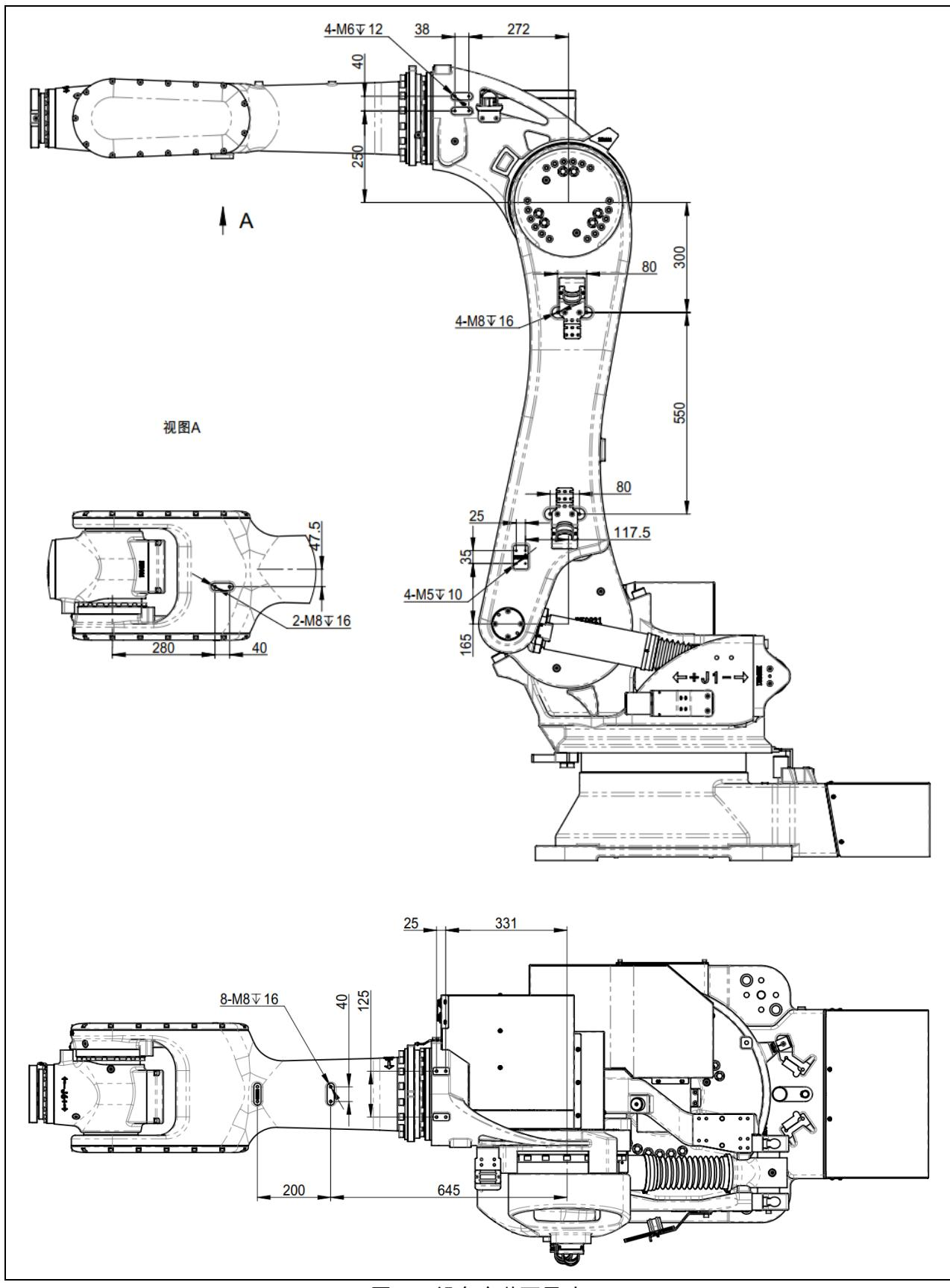
图 4.2 设备安装面尺寸
