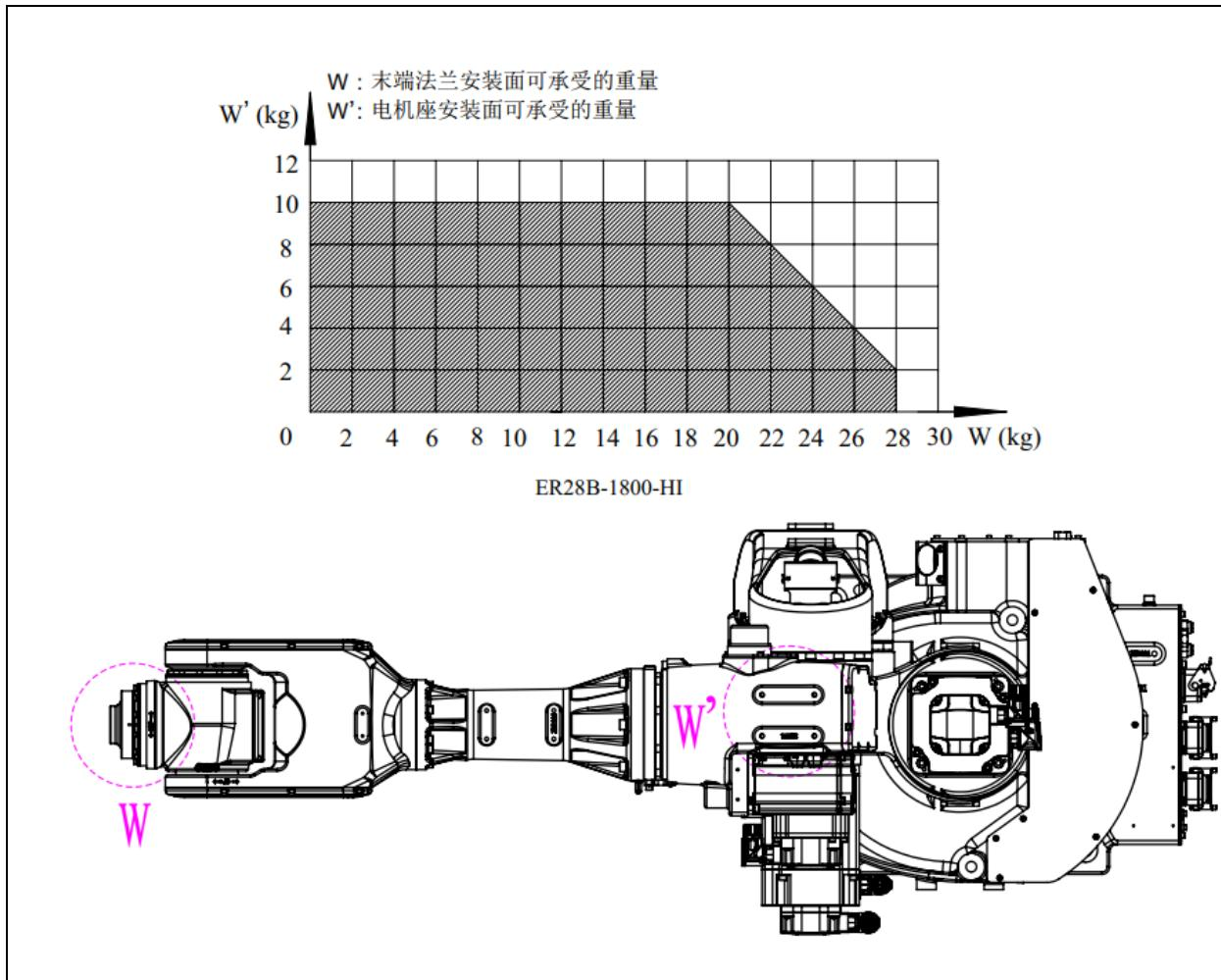
图 3.6 附加负载示意图(ER28B-1800-HI)
