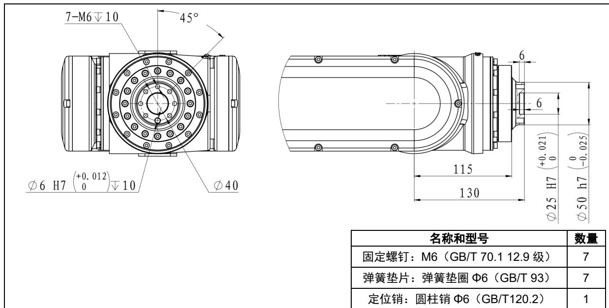
图 4.1 末端法兰安装接口 (ER28B-1800-HI)
