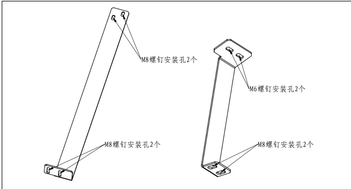
图 1.1 机器人固定支架示意图 (ER28B-1800-HI)
