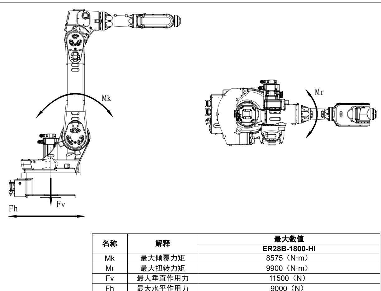
图 1.4 机器人底座受力数据
