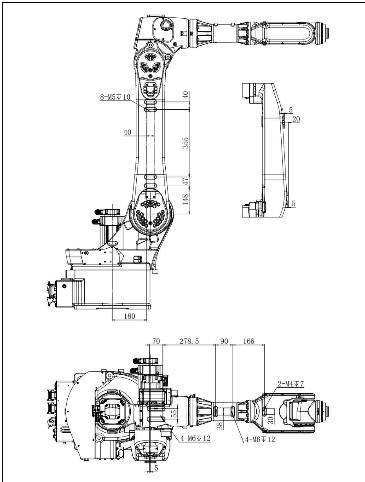
图 4.2 设备安装面尺寸 (ER28B-1800-HI)
