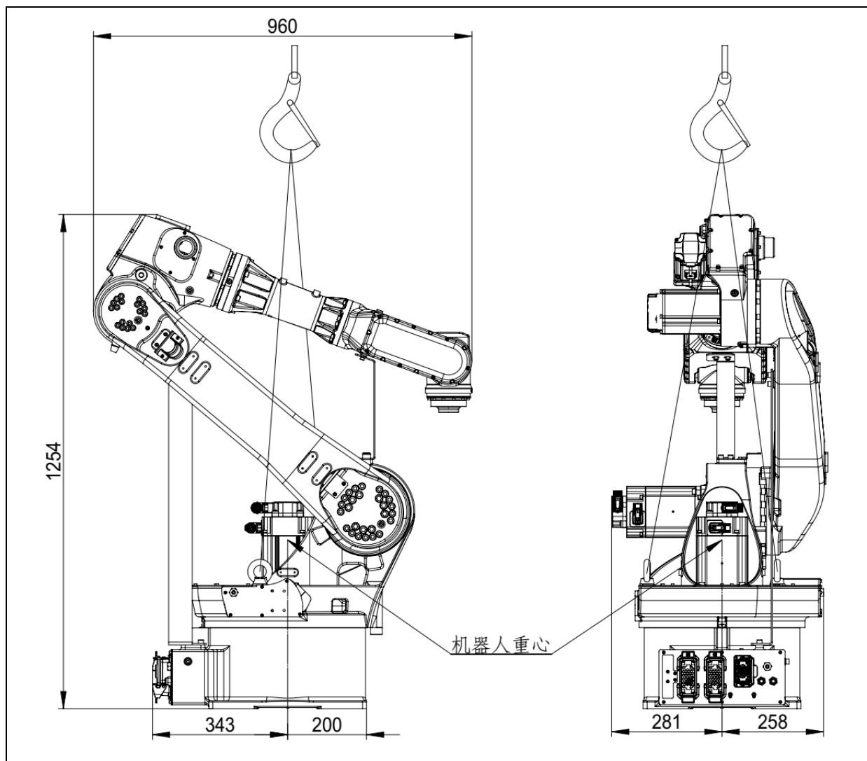
图 1.3 机器人起重机搬运示意图 (ER28B-1800-HI)
