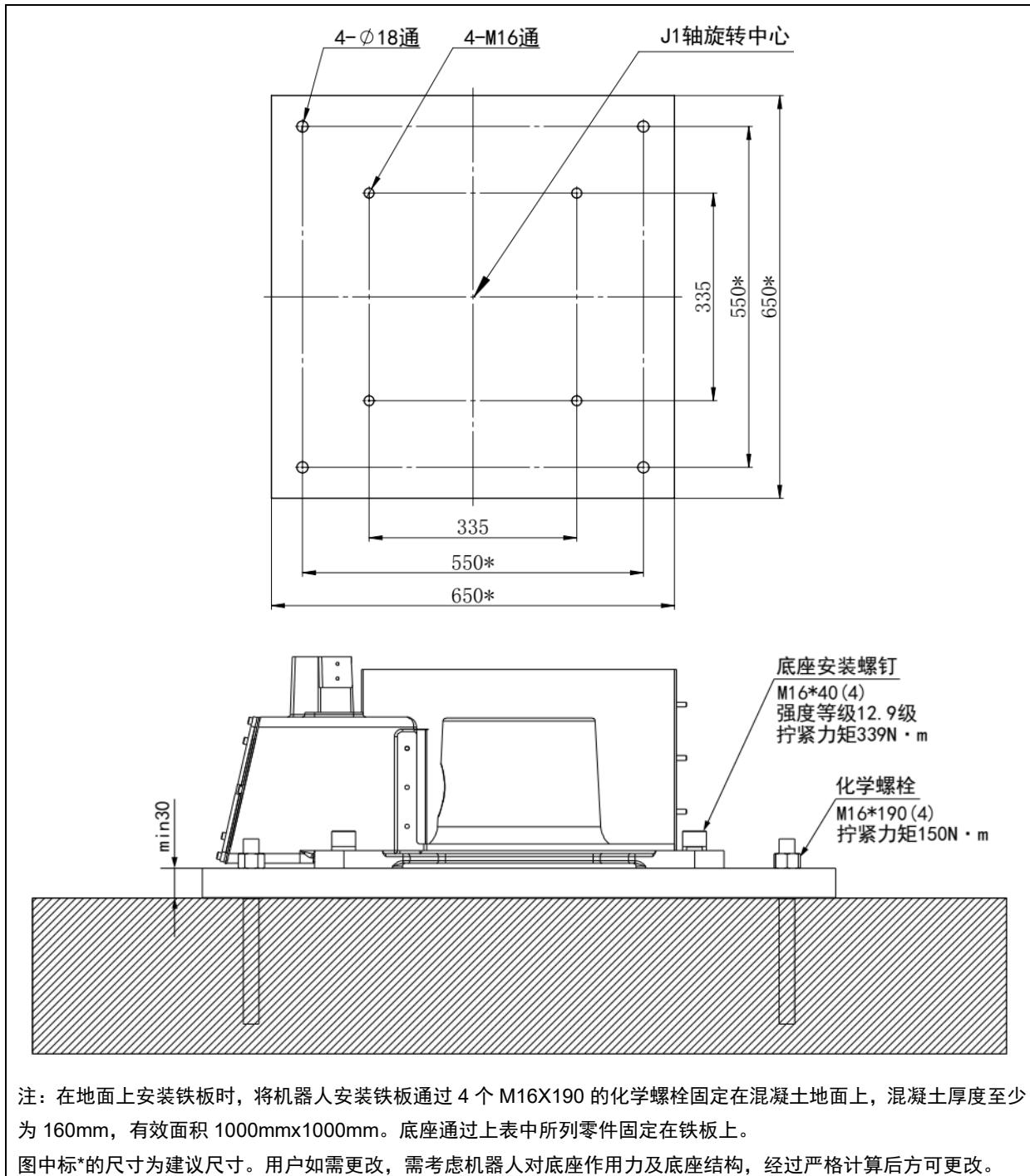
注：在地面上安装铁板时，将机器人安装铁板通过 4 个 M16X190 的化学螺栓固定在混凝土地面上，混凝土厚度至少为 160mm，有效面积 1000mmx1000mm。底座通过上表中所列零件固定在铁板上。
