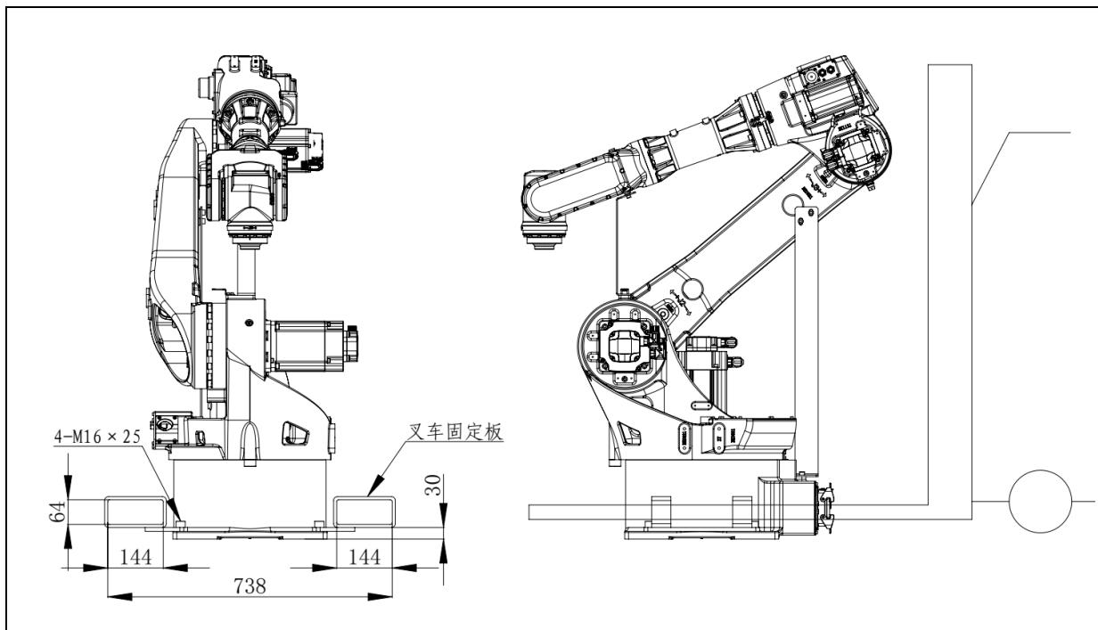
图 1.2 机器人叉车搬运示意图 (ER28B-1800-HI)
