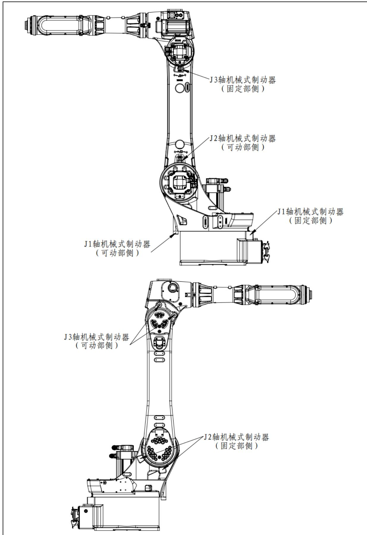
图 3.4 机械式制动器位置 (ER28B-1800-HI)
