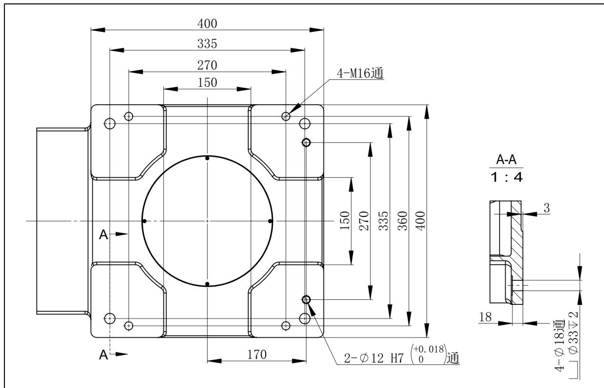
图 1.5 机器人底座安装尺寸
