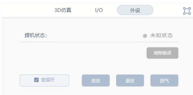
在外设选项卡界面下可以控制已经适配外部设备的动作，如焊机的“送丝”，“退丝”，“送气”等。
