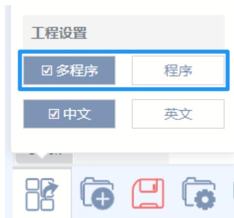
切换为多程序后可点击如下图的工程编辑界面的 1 当前程序名或 2 工程属性编辑进行新建子程序。点击当前程序名后在弹出的下拉菜单中可对当前编辑的程序进行切换。
