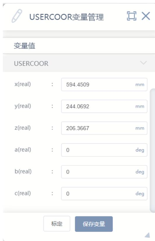
在执行完“三点标定法”得到用户坐标系后，可在随后的 move 指令中作为变量被调用。
