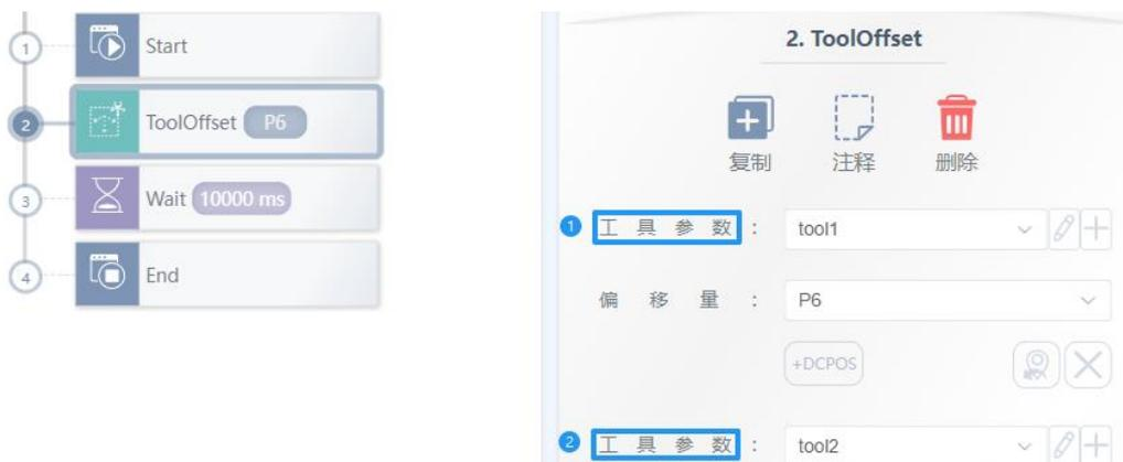
其中 1 表示偏移前的工具参数，2 表示偏移后的工具参数。
