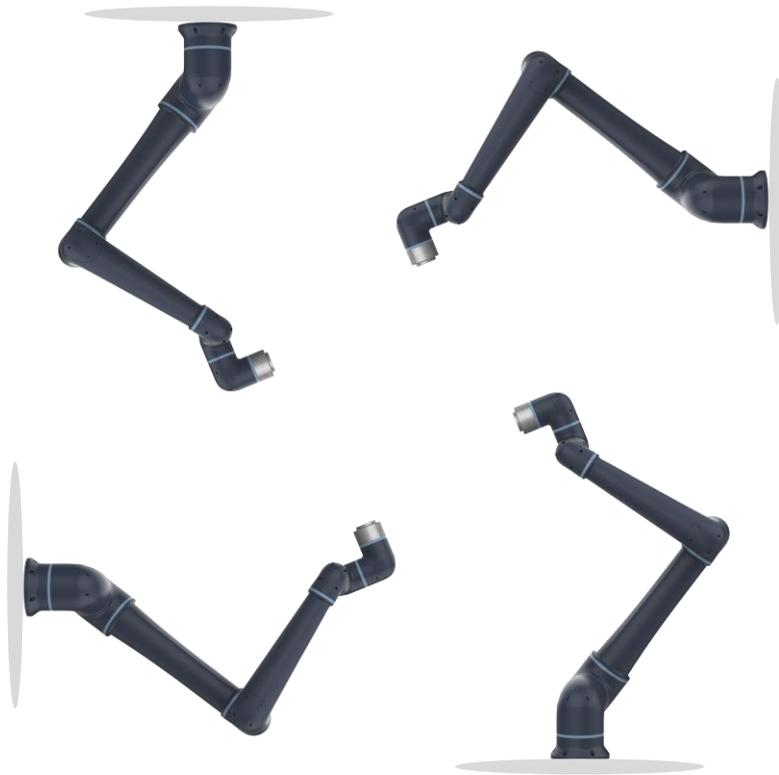
图 3-3 机器人典型安装角度
