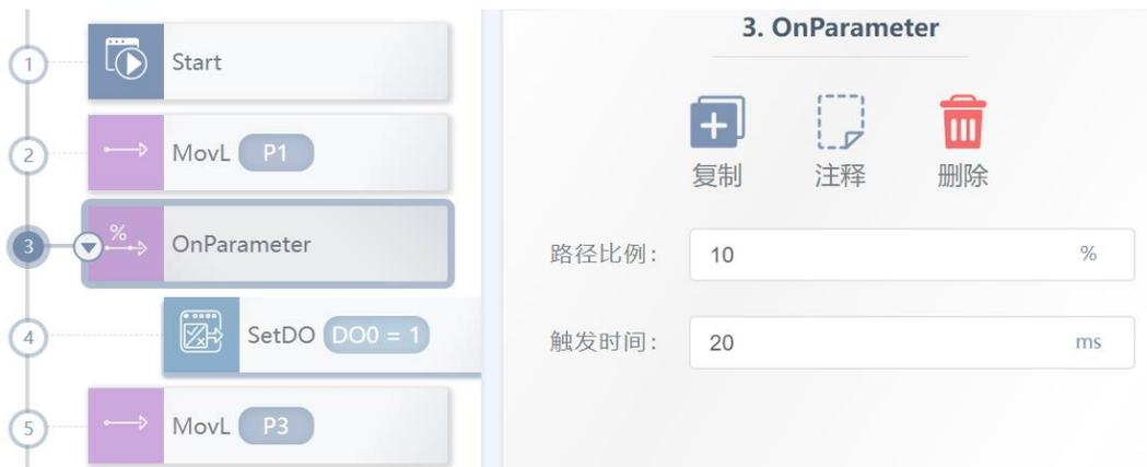
图例表示机器人 TCP 从 P1 移动至 P3 过程中，运动至 10%位置的提前 20ms 进行设置 DO0 为 1。若将触发时间 20ms 改为 -20ms 则表示运动至 10%位置提前 20ms 进行设置 DO0 为 1
