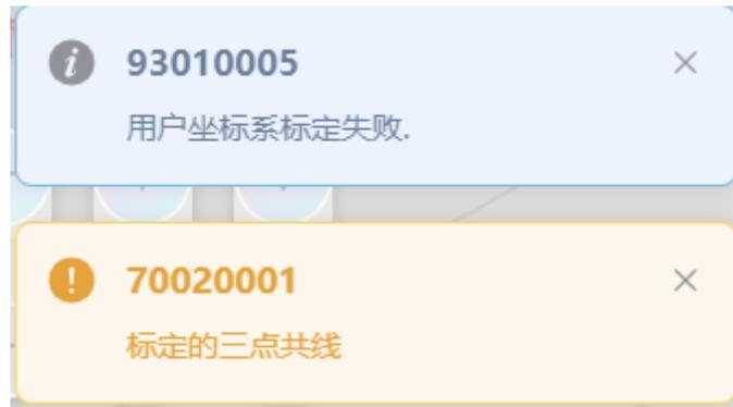
如果“标定 USERCOOR”窗口并没有自动填入任何值且伴随“用户坐标系标定失败”提示则表示标定失败。
