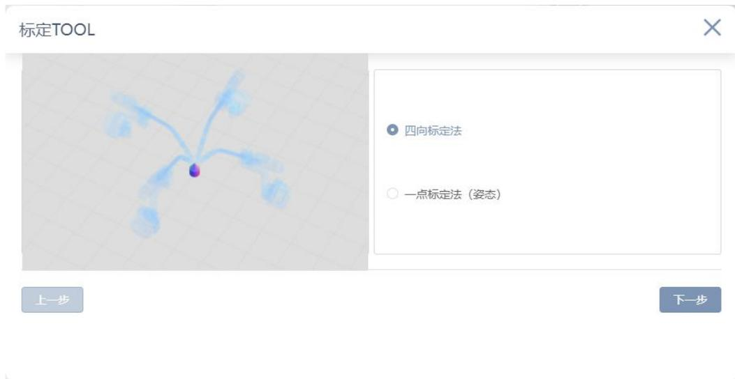
任意移动机器人（点动或拖拽）至四个不同的位姿，每一次都使工具点与空间中放置的同一个针尖接触并点击“方向示教”按钮。执行完四个位姿后以得到 TCP 相对于工具输出法兰中心的平移关系。
