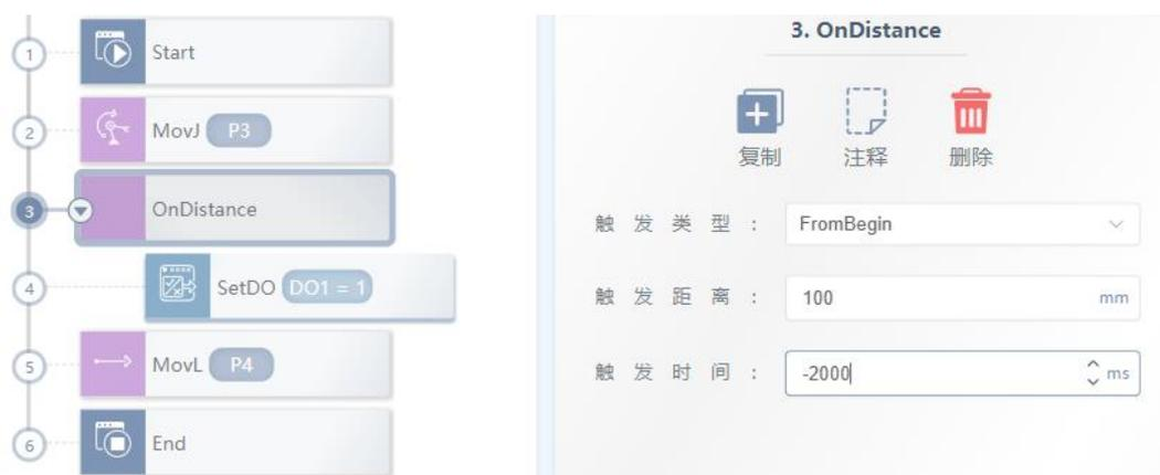
图例表示机器人 TCP 从 P3 移动至 P4 过程中，运动至 100mm 位置的提前 2000ms 进行设置 DO1 为 1。若将触发时间-2000ms 改为 2000ms 则表示运动至 100mm 位置后 2s 进行设置 DO1 为 1
