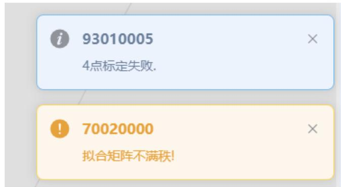
如果“标定 TOOL”窗口并没有自动填入任何值且伴随“4 点标定失败”提示则表示标定失败。
