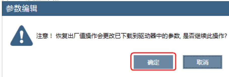
步骤 3 ESView V4 将发送恢复出厂值命令至驱动器，设备将开始执行恢复出厂值操作。
