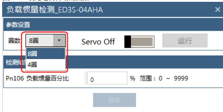
步骤 5 点击“Servo Off/Servo On”的开关，使电机通电，如图 8-38 所示。
