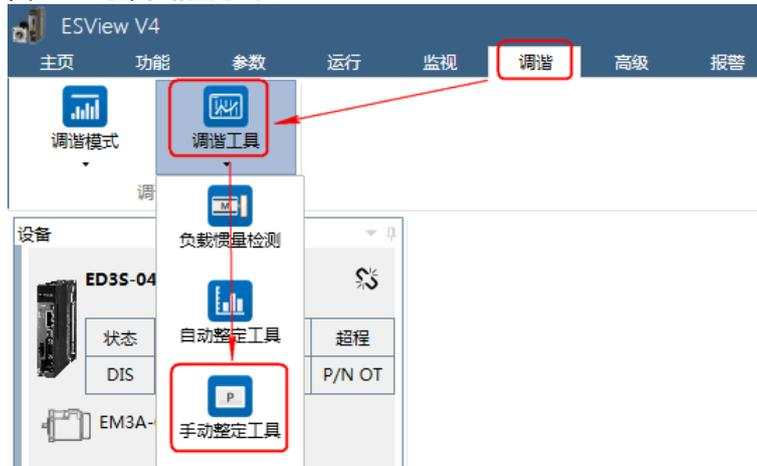
“功能显示区”将显示“手动整定工具”的窗口，如图 8-12 所示。
