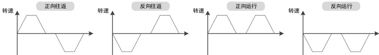
用户应恰当地设定旋转圈数和最高转速，如果旋转圈数设定较小或最高转速设定较大，则可能会出现达不到所设定的最高转速。此时，应增加旋转圈数的设定值或降低最高转速的设定值。
