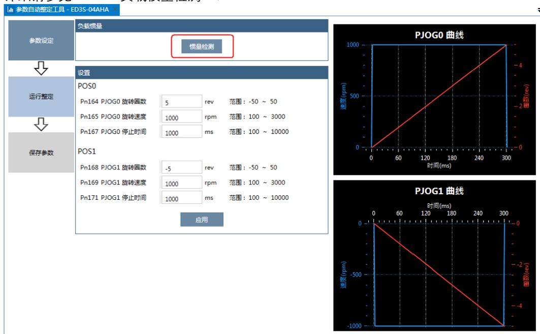
步骤 5 设定 POS0 和 POS1 两个程序的相关参数。
