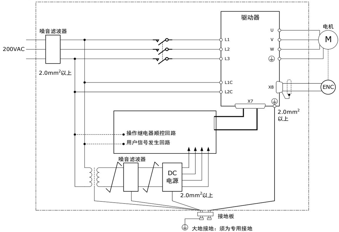
【说明】 接地用的地线请尽量使用2.0mm<sup>2</sup>以上的粗线（平扁铜线较适合）。
