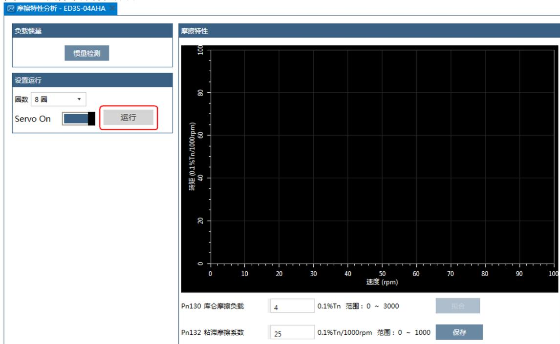
步骤 8 等待电机运行完毕后，会将其摩擦特性的检测结果描绘在右侧的示意图中，如图 8-59 所示。
