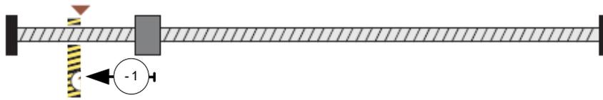
注意：在使用与限位开关有关的回零方式时，启动回零时电机的旋转方向与限位开关的初始状态有关，必要时可以通过输入口取反的方式改变其初始状态。
