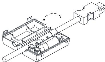
步骤 3 拆下旧电池，并装上新电池。
