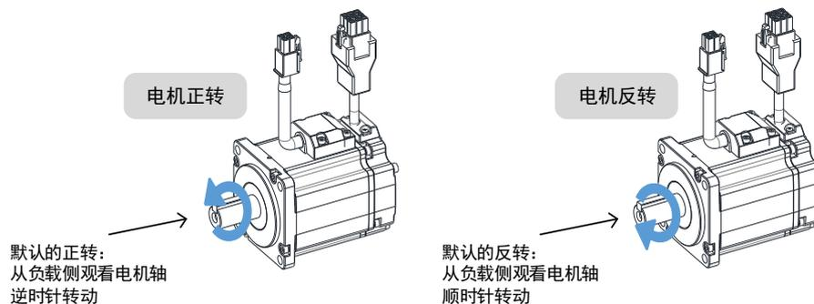
【注】伺服电机的旋转方向取决于用户参数 Pn001.0 的“旋转方向的选择”。上图所示为 Pn001.0 的出厂设定。
