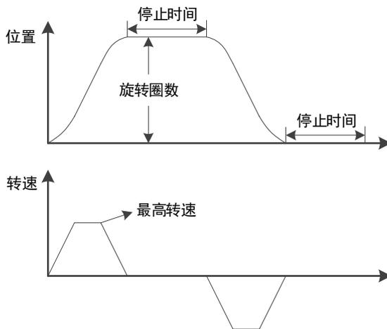
执行 PJOG 时，驱动器会按照这两个位置节点的参数设定反复运作电机，直至用户手动停止结束。其中，旋转圈数 (Pn164 和 Pn168)，可设定为正值或负值，表示电机转动的方向。
