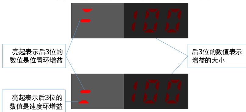
步骤 5 完成执行自动整定功能后，将显示执行的结果。
