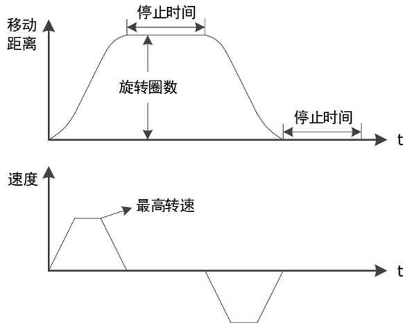
使用自动整定工具时，驱动器会按照这两个位置节点反复运作电机，直至调整结束。其中，旋转圈数（Pn164 和 Pn168），可设定为正值或负值，表示电机转动的方向。因而，电机运动可以实现如图 8-9 所示的方式。
