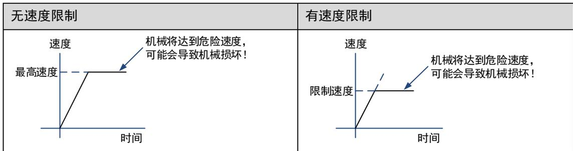
【说明】根据电机的负载条件，电机的限制速度与设定值之间会有一定差距。
