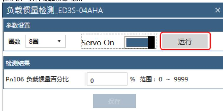
步骤 7 等待负载惯量检测操作执行完毕后，ESView V4 会将检测结果显示在对话框中，如图 8-40 所示。
