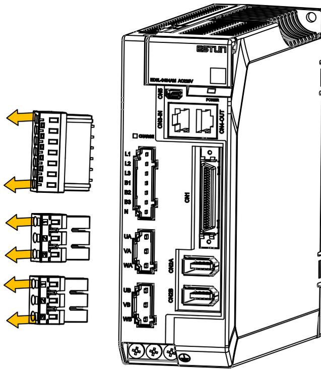
步骤 2 使用接线钳剥下连接电线的外层，一般为 8mm~9mm。
