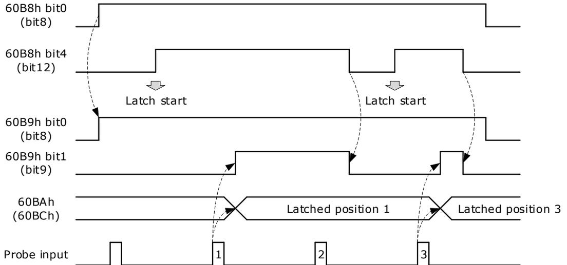
• 连续触发模式 Continuous Trigger Mode (60B8h bit1=1, or bit9=1)
