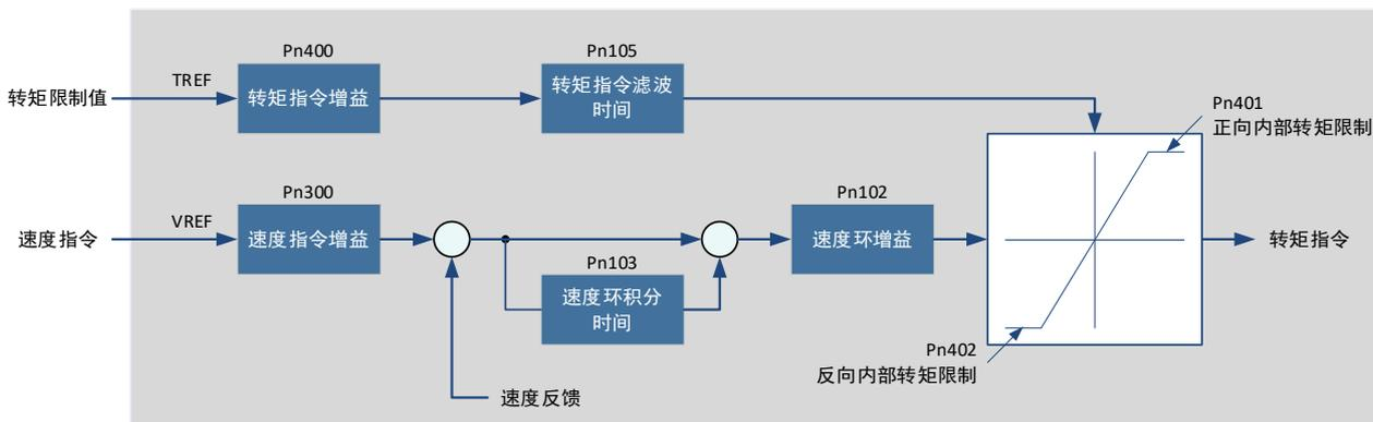
**【说明】** 用于转矩限制的模拟量指令的输入电压没有极性。无论是 + 电压还是 - 电压，只取电压的绝对值，将与该绝对值相应的转矩限制值同时用于正转和反转。
