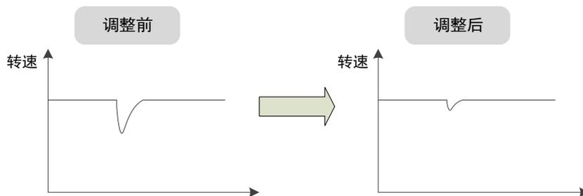
负载转矩补偿功能是通过负载转矩观测器观测负载转矩，然后将该转矩补偿至转矩给定中，从而达到负载转矩补偿的效果。
