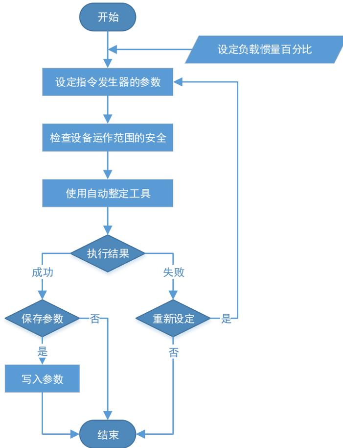
在使用自动整定工具时，将自动对如下参数进行调整。
