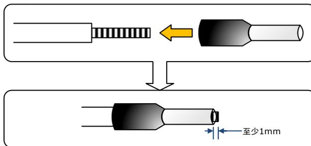
步骤 4 使用接线钳压制已套有冷压端子的电线，并剪去露出的线头（允许露出部分不超过 0.5mm）。
