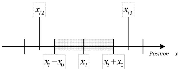
上图描述了对“following error”，窗口功能是如何定义。 $x_i - x_0$  和  $x_i + x_0$  范围(位置跟随误差窗口)对称地分布在期望位置(position\_demand\_value)两边。举例，位置  $x_{i2}$  和  $x_{i3}$  都位于位置跟随误差窗口外。如果驱动器离开窗口后，在设定时间(following\_error\_time\_out)内没有返回窗口内，那么状态字(statusword)的 bit13(following\_error)将被置 1。
