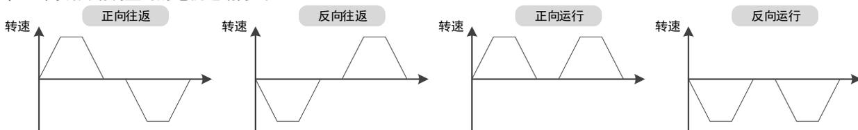
用户应恰当地设定旋转圈数和最高转速，如果旋转圈数设定较小或最高转速设定较大，则可能会出现达不到所设定的最高转速。此时，应增加旋转圈数的设定值或降低最高转速的设定值。
