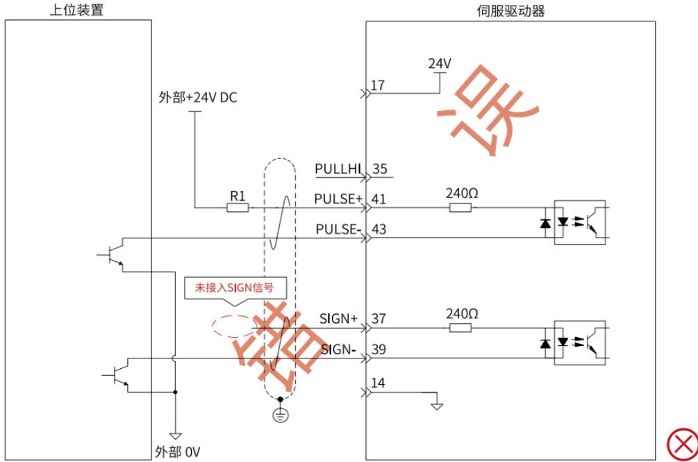
错误 4: 端口接错, 导致端口烧损
