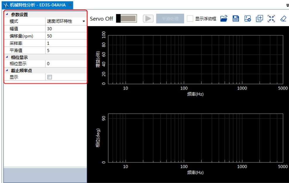
步骤 4 点击“Servo Off/Servo On”的开关，使电机通电，如图 8-45 所示。
