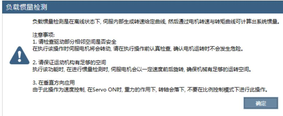
步骤 3 请仔细阅读执行负载惯量检测操作的注意事项，然后点击“确定”。
