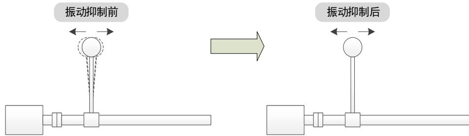
该功能基于模型追踪控制，根据模型环中的负载位置和电机位置之间的关系，以控制负载端位置稳定为目的，修正电机端的位置指令，同时修正模型生成的前馈量，达到低频振动抑制的目的。其工作示意如图 8-34 所示。
