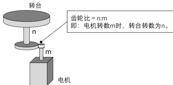
此时，为了使电机的转数和转台在整数比的关系中不出现尾数，需设定“多圈设定上限值”Pn228（对象 30A9h）。
