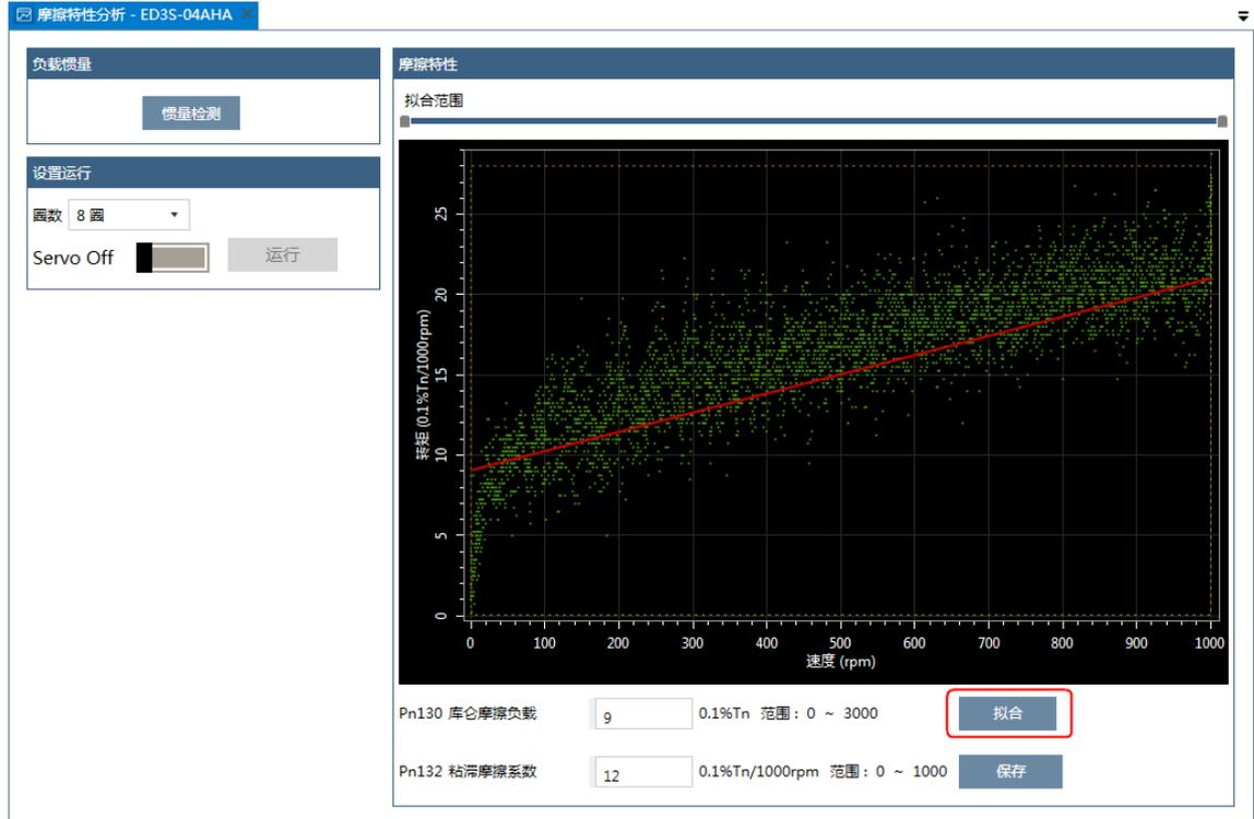
步骤 11 点击“保存”，将自动将“Pn130 库仑摩擦负载”和“Pn132 粘滞摩擦系数”的结果下载至驱动器中。
