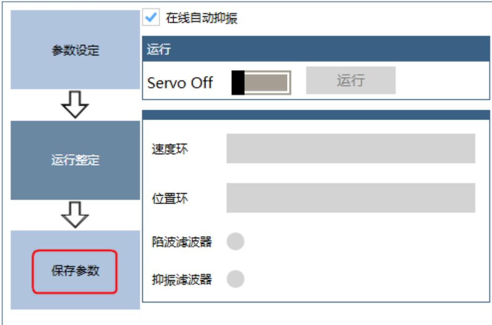
步骤 14 请检查“整定结果”，然后点击“保存”，ESView V4 将自动下载相关的参数至驱动器中。
