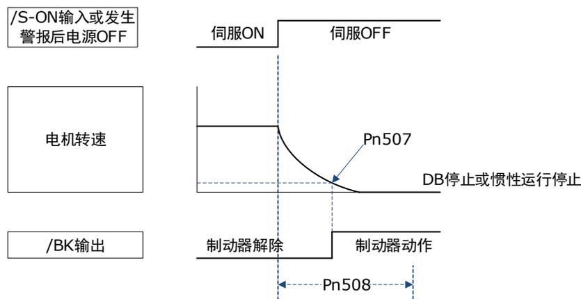
以下任意一项条件成立时，将/BK 信号设定为 H 电平(制动器制动)。
