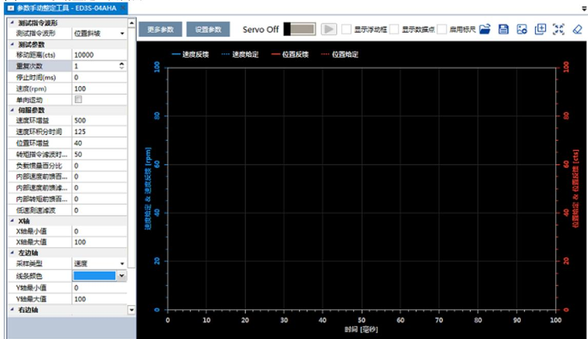
使用手动整定工具时，根据所选择的测试曲线，可以调整和优化位置环、速度环的参数。
