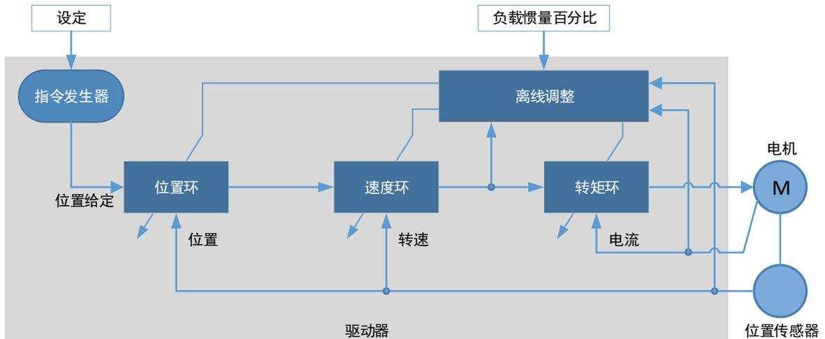
使用调谐工具达到较优性能的前提是正确设置负载惯量百分比 Pn106，用户可以通过计算或分析工具（负载惯量检测）等途径获取，也可通过控制器实时修改。
