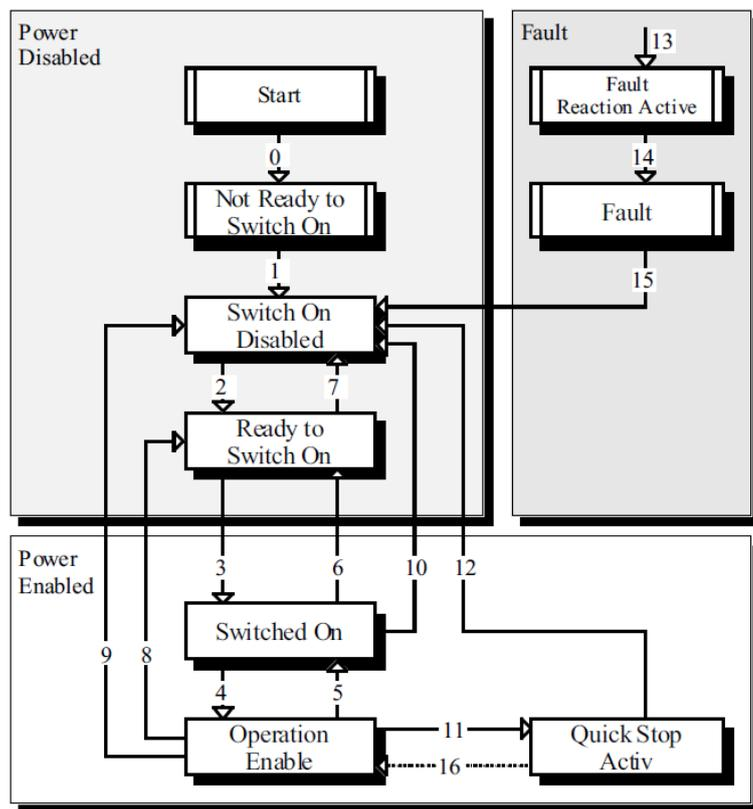
如上图所示，状态机可以分成三部分：“Power Disabled”(主电关闭)、“Power Enabled”(主电打开)和“Fault”。所有状态在发生报警后均进入“Fault”。在上电后，驱动器完成初始化，然后进入 SWITCH\_ON\_DISABLED 状态。在该状态，可以进行 CAN 通讯，可以对驱动器进行配置（例如，将驱动器的工作模式设置成“PP”模式）。此时，主电仍然关闭，电机没有被励磁。经过 State Transition(状态传输)2、3、4 后，进入 OPERATION ENABLE。此时，主电已开启，驱动器根据配置的工作模式控制电机。因此，在该状态之前必须先确认已经正确配置了驱动器的参数和相应的输入值为零。State Transition(状态传输)9 完成关闭电路主电。一旦驱动器发生报警，驱动器的状态都进入 FAULT。
