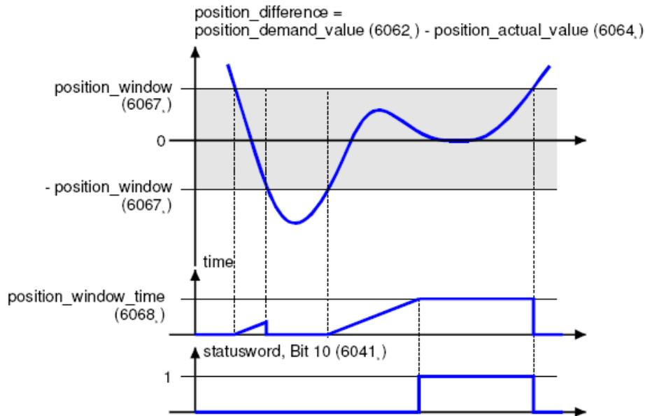
下图显示 位置窗口(position\_windows)对称分布在目标位置(target\_position)附近, 即  $x_i - x_0$  到  $x_i + x_0$  区间范围。举例, 位置  $x_{t0}$  和  $x_{t1}$  在位置窗口(position\_windows)内。如果驱动器在窗口内, 一个定时期开始计时。如果定时期达到设定值(position\_window\_time)且期间驱动器位置一直位于窗口内, 那么状态字(statusword)的 bit10(target\_reached)将被置 1。驱动器位置一离开该窗口, 状态字的 bit10(target\_reached)将立即被清零。
