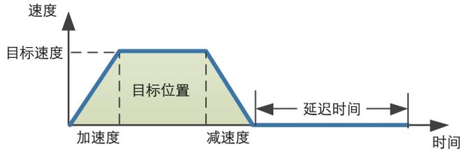
插断时的位置规划，在原指令速度的基础上进行位置指令规划。
