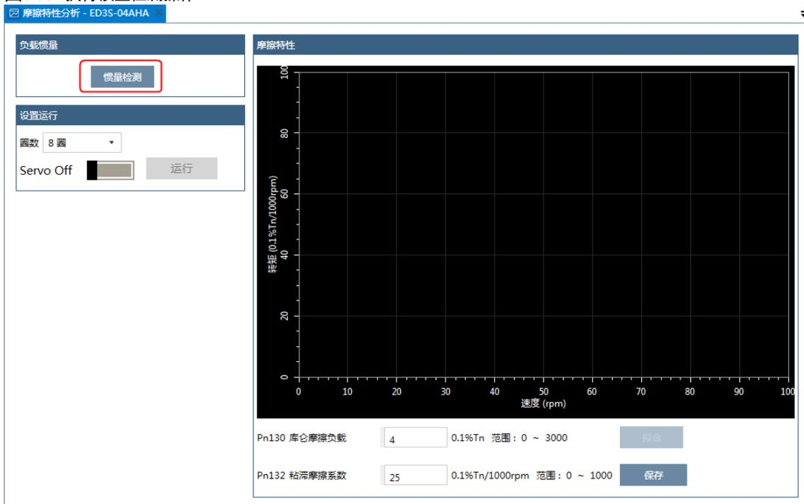
步骤 5 选择执行摩擦特性分析操作时电机转动的“圈数”，如图 8-56 所示。
