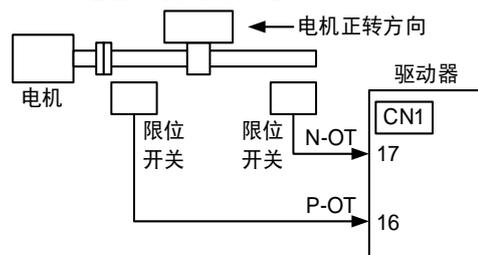
若驱动器使用在圆台及输送机等旋转型负载时，通常不需要使用超程防止功能，此时无需对超程防止用的输入信号进行接线。
