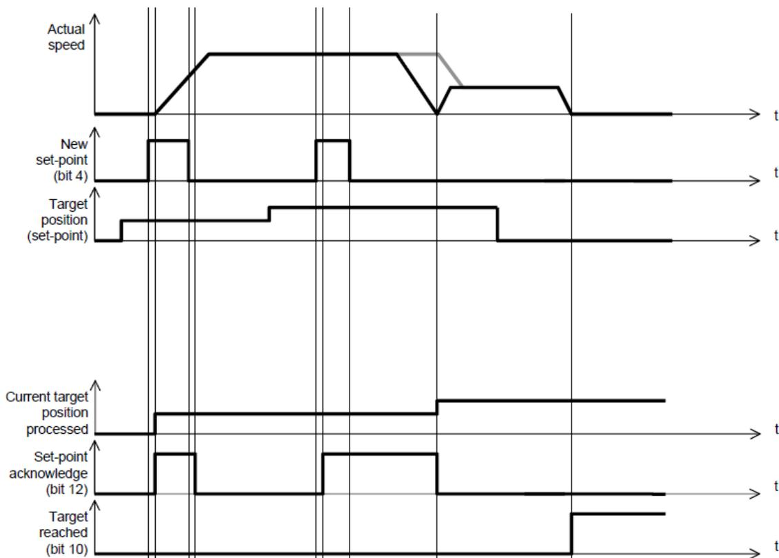
在速度曲线选择为 S 形时 (motion\_profile\_type=2)，仅支持**连续设定**方法，使用 6083h (profile\_acceleration) 限制其最大加速度，6081h (profile\_velocity) 限制其最大速度，使用 60A4-01 h (VAR Profile\_jerk1) 设置其加加速度。目前只支持对称的 S 形曲线规划。
