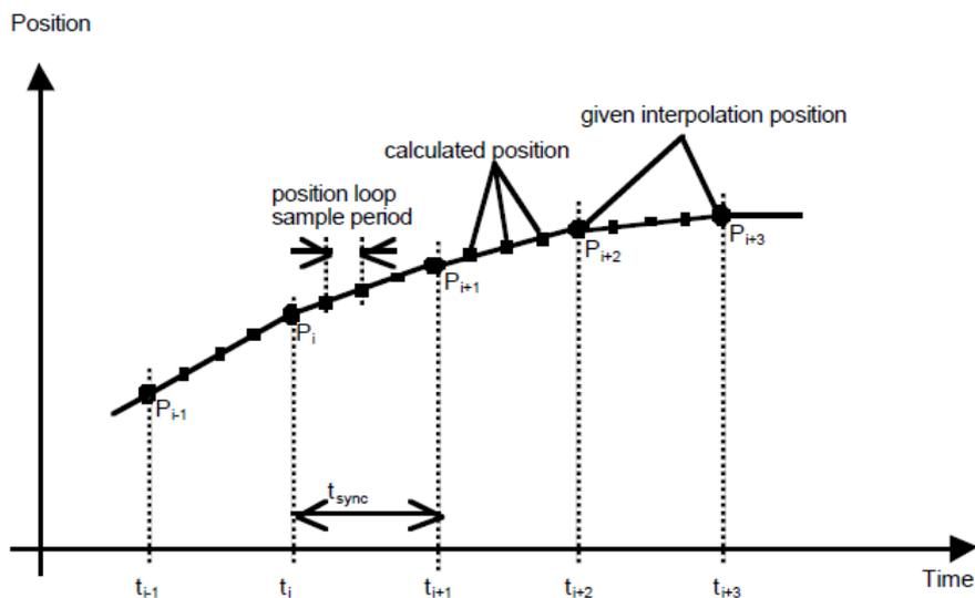
其中  $P_i$  表示上位机发送的插补位置， $t_{sync}$  表示设定的同步周期；
