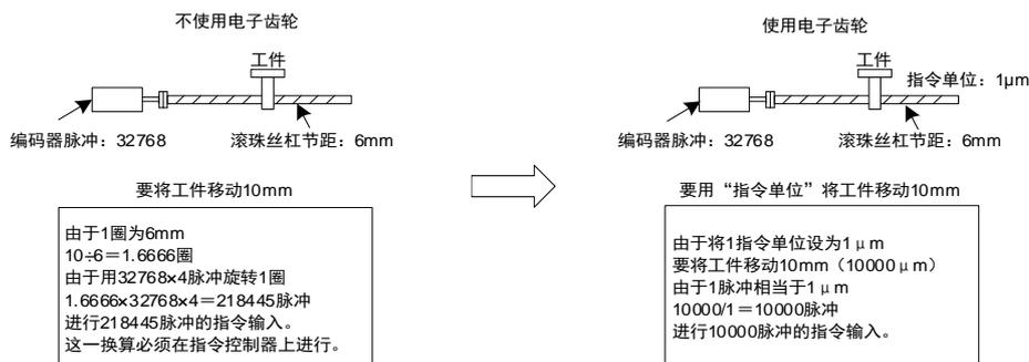
如果将电机轴与负载侧的机械减速比设为  $m/n$ ，则可由下式求出电子齿数比的设定值。（伺服电机旋转  $m$  圈、负载轴旋转  $n$  圈时）
