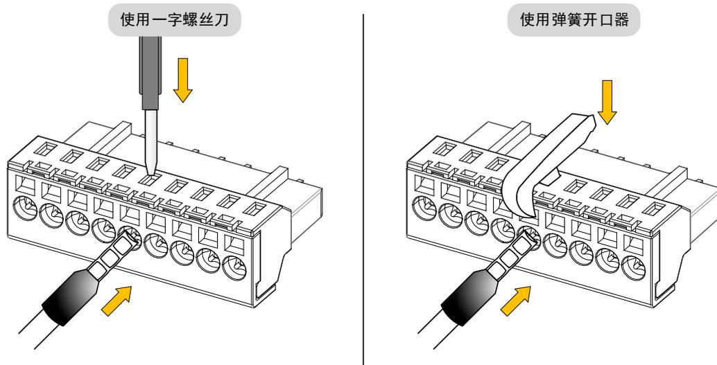
步骤 6 电线插入端子后，拔出弹簧开口器或一字螺丝刀。
