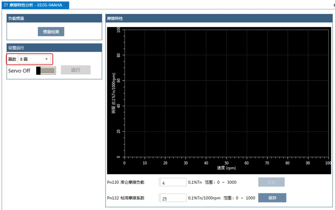
步骤 6 点击“Servo Off/Servo On”的开关，使电机通电，如图 8-57 所示。
