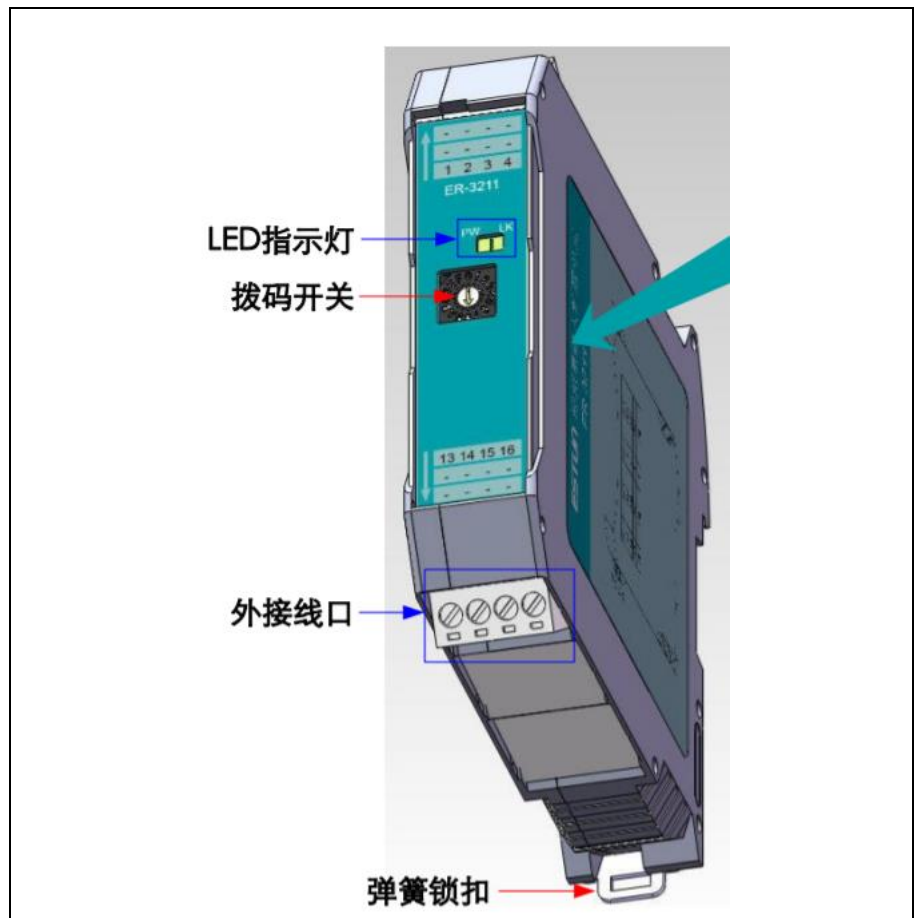
图 6.4 数字输出 ER-3211 接口图示
