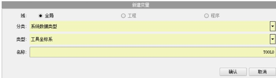
步骤 3 确认所要新建的工具坐标系变量设置无误后，点击“确认”。
