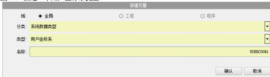
步骤 3 确认所要新建的用户坐标系变量设置无误后，点击“确认”。
