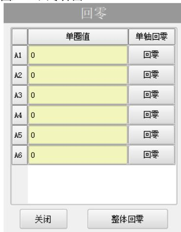
单轴回零：点击对应轴后“回零”按钮，执行单轴回零操作；
