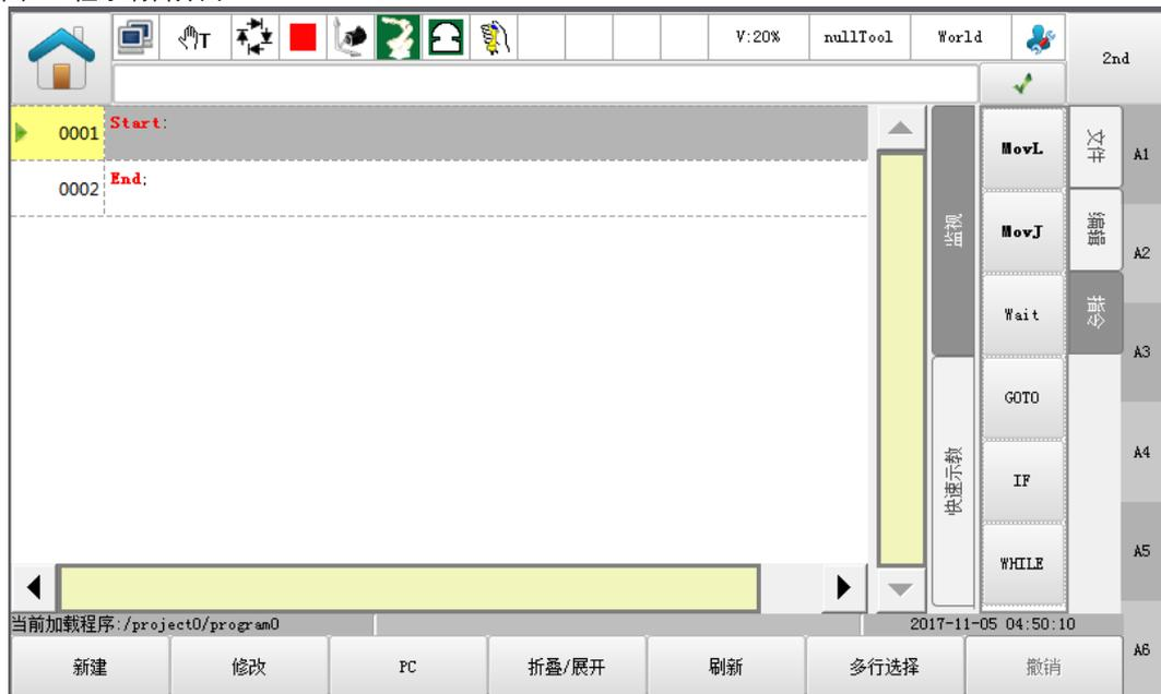
步骤 7 在程序界面中进行指令编辑，控制机器人运动的指令就是运动指令。在移动指令中，记录有移动的位置、插补方式、再现速度等(其他指令类型详见附录基本指令类型)。
