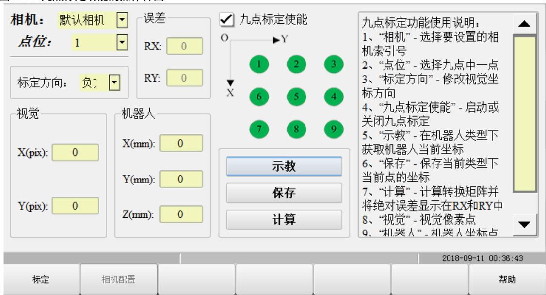
步骤 2 设置视觉坐标和机器人坐标。
