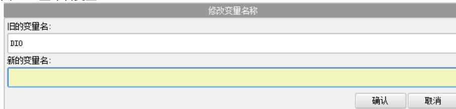
点击“新的变量名”的输入框，并在弹出的软键盘中键入想要的名称，再点击“确认”，该变量将被重命名。
