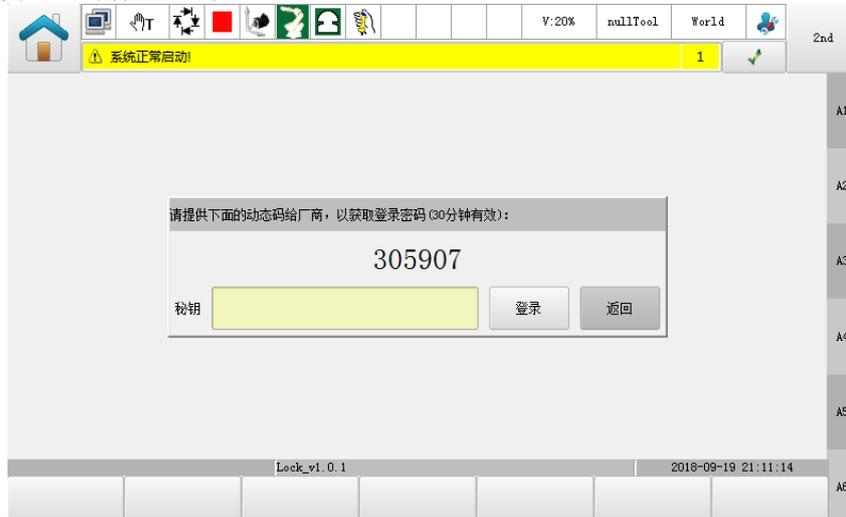
步骤 2 登录清除锁定设置界面如图 12-70 所示，根据提示的机器码，提供给厂商人员获取清除解锁密钥。
