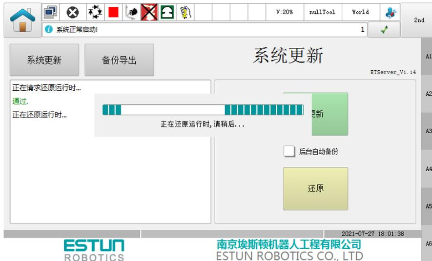
图12-29 控制器程序还原结束界面
