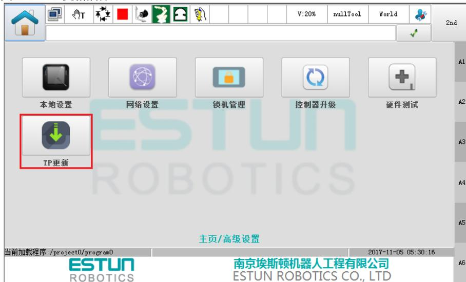
步骤 3 进入如图 12-20TP 更新界面，勾选“开机同步更新示教器”，启用示教器同步更新方式。
