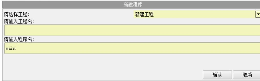
步骤 3 若要新建一个工程，在“请选择工程”右侧的下拉列表中选择“新建工程”。
