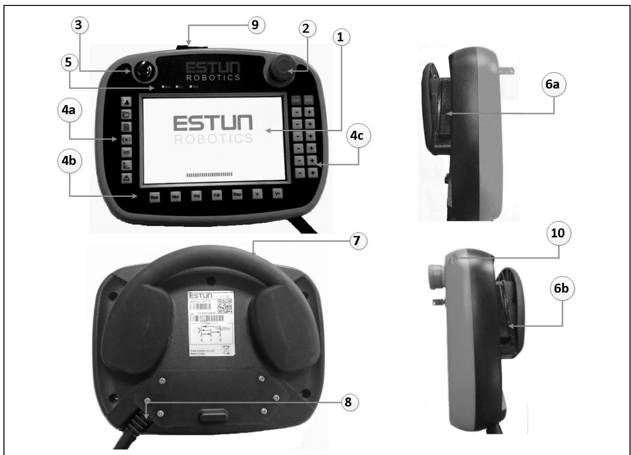
图 1.4 ESTUN 示教器按钮示意图
