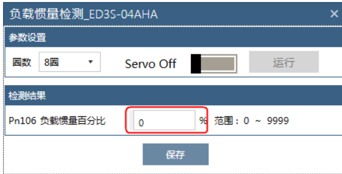
图9-40 负载惯量检测结果
