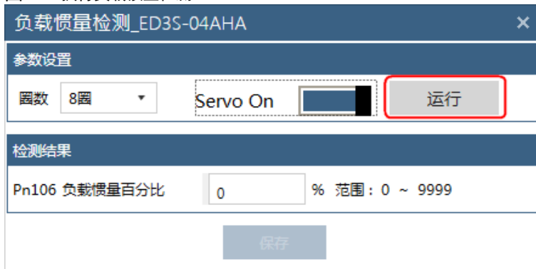
图9-39 执行负载惯量检测
