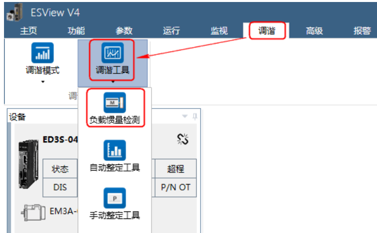
图9-35 选择负载惯量检测
