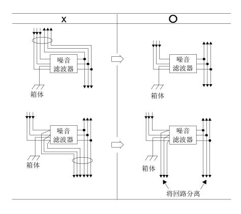
噪音滤波器的地线请与输出接线分开设置。另外,地线请勿与噪音滤波器的输出接线及其他信号线使用同一套管,也不要将 其捆扎在一起。
