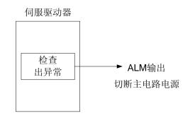
由ALM所构成的外部电路必须做到:该报警的输出可以使通向伺服驱动器的电源关断。
