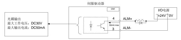
请在外部准备+24V的 I/O 用电源, 伺服驱动器内部没有提供+24V 电源。
