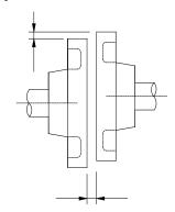
在一圈的四等分处进行测定,最大与最小的差小于 0.03mm。(与联轴器一起旋转)
