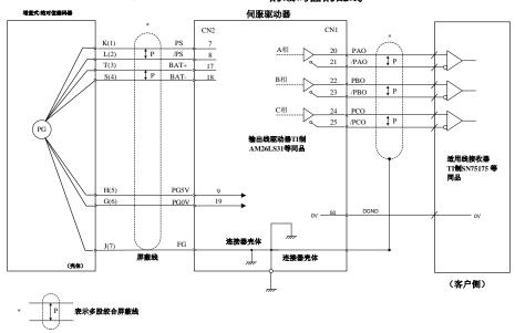
注: (1)增量式编码器时无BAT+、BAT-信号。 (2)编码器插头连接器针号因电机型号不同而有所区别。
