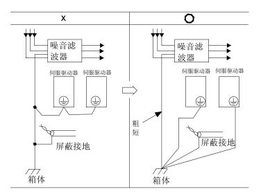
控制柜内部有噪音滤波器时,请将噪音滤波器的地线和控制柜内其他设备的地线,连接在控制柜的接地板上之后再进行接地。
