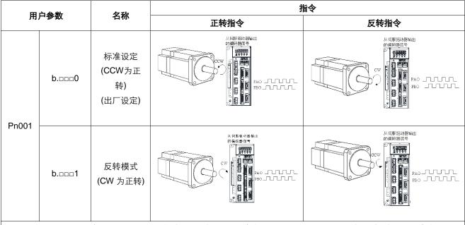
切换P-OT, N-OT 的方向。Pn001=b.□□□0(标准设定)时, CCW方向为P-OT, Pn001=b.□□□1(反转模式)时, CW方向为P-OT。
