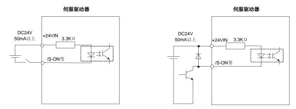
选用继电器触点输入时,应选用微小电流用继电器,否则易造成信号接收不良。
