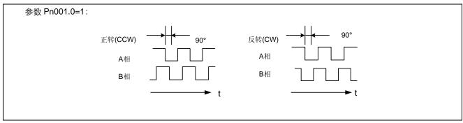
非绝对值编码器电机请在将伺服电机旋转两圈之后,再使用伺服驱动器的 C 相脉冲输出进行机械原点复位动作。
