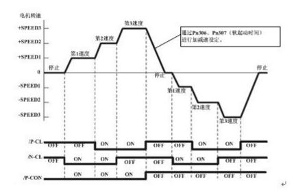
设定为"Pn005.1=3 速度控制(接点指令) 〈 位置控制(脉冲列指令)"时,软起动功能仅在速度接点控制时起作用。在脉冲指令输入时,不能使用软起动功能。如果正在以第1~第3速度中的任一速度运行时切换至脉冲指令输入,伺服驱动器则在定位完成信号(/COIN)输出后受理脉冲指令。请务必在伺服驱动器的定位完成信号输出后,再开始输出用户指令控制器的脉冲指令。
