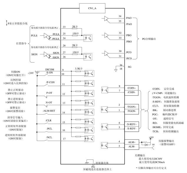
注: CN1\_A、CN1\_B、CN1\_C 接线图一致。
