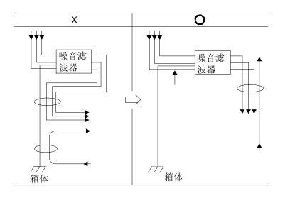
将噪音滤波器的地线单独连接在接地板上。请勿连接其他地线。
