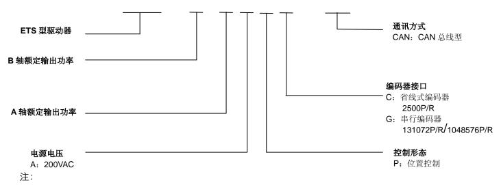
ETS 两轴驱动器每个轴适配电机功率为 50W、100W、200W、400W、750W、1.0kW,且满足三倍过载能力。
