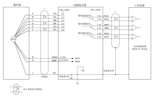
注: 1、电机型号不同,则编码器引脚序号与信号的对应关系可能改变,请按照实际对应关系接线。
